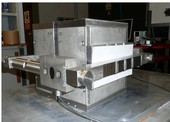
Figura 4.2 Scatola montata con il confinamento laterale
