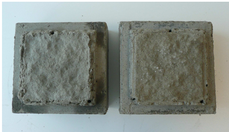
Figura 4.9 Due provini visti dall'alto: si vedono i 3 fori lasciati dai "chiodi".
