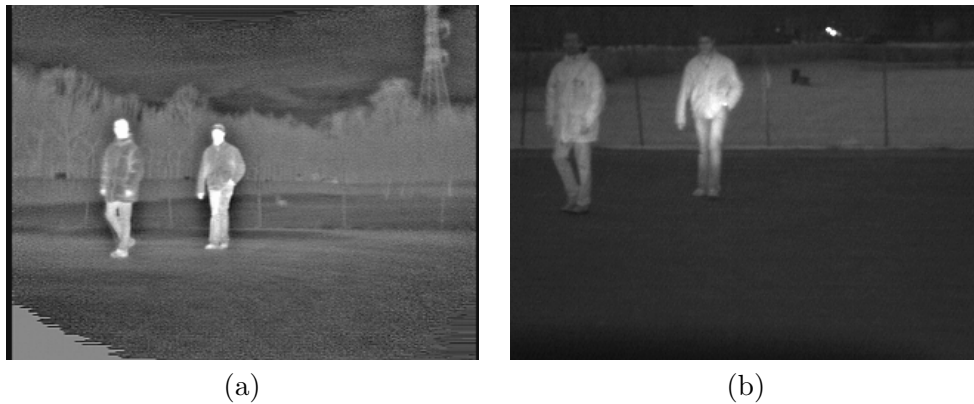
Figura 5.1: La stessa scena notturna, acquisita nello spettro del FIR (a) e del NIR (b) - con scarsa illuminazione esterna.
