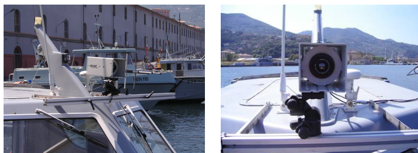
Figura 10.4: La telecamera termica installata sulla cabina dell'imbarcazione.
