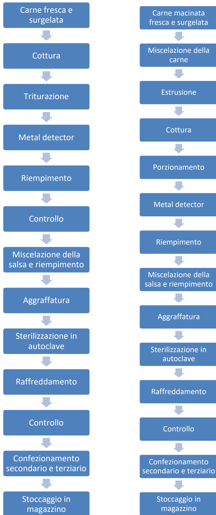
Figura 23 Processo produttivo della linea Natura (a) e Paté (b)
