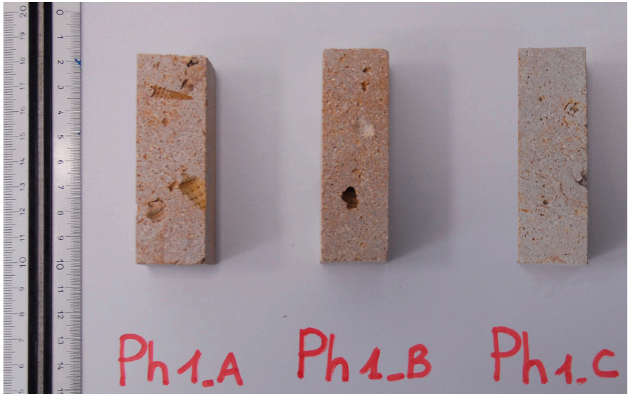
Figura 1.2.34 – I campioni di pietra del Panthéon utilizzati per la prova di compressione.
