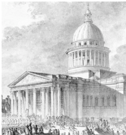
Figura 2.3.3 – Meunier, Procession devant Sainte Geneviève en 1778 . Nel disegno si nota la localizzazione delle finestre prima dell'occlusione apportata da Rondelet 13 .
