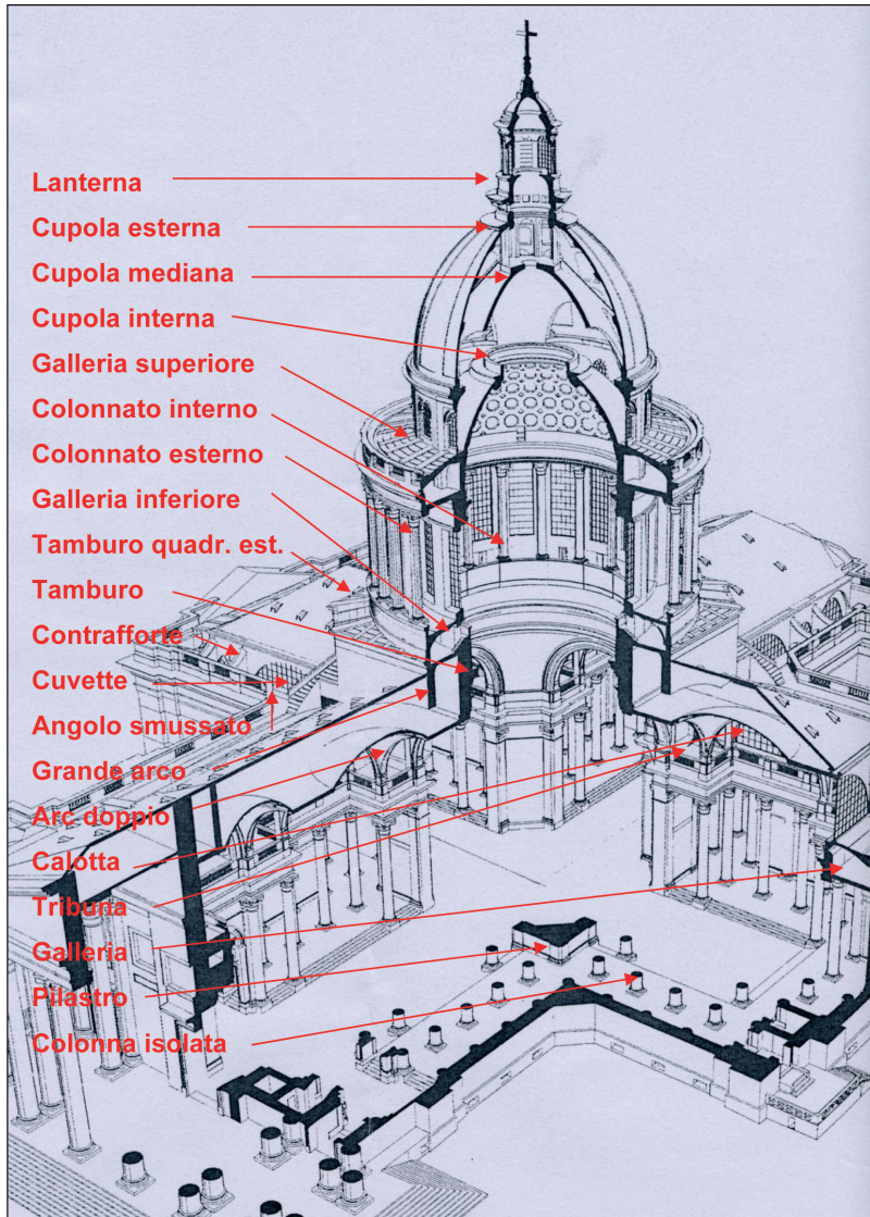
Figura 2.2.1 – Principali componenti della struttura del Panthéon 2 .
