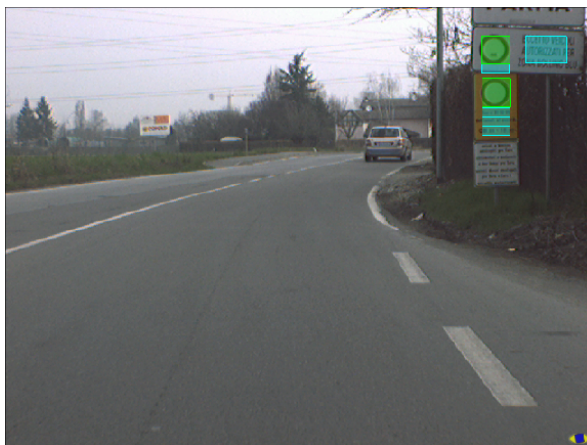
Figura 6.14: Esempio di un falso positivo, sotto il cartello di divieto d'accesso più in alto, causato dal bordo orizzontale del cartello contenuto nell'espansione ed erroneamente considerato come bordo orizzontale di un possibile disegno contenuto nel pannello integrativo.
