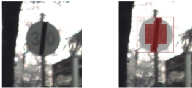
Figura 5.12: Esempio di maschera applicata al bbox in fase di calcolo della trasformata di Hough. Essa permette di limitare i contributi di rumore apportati dalla banda e da un'eventuale disegno presente nel cartello.
