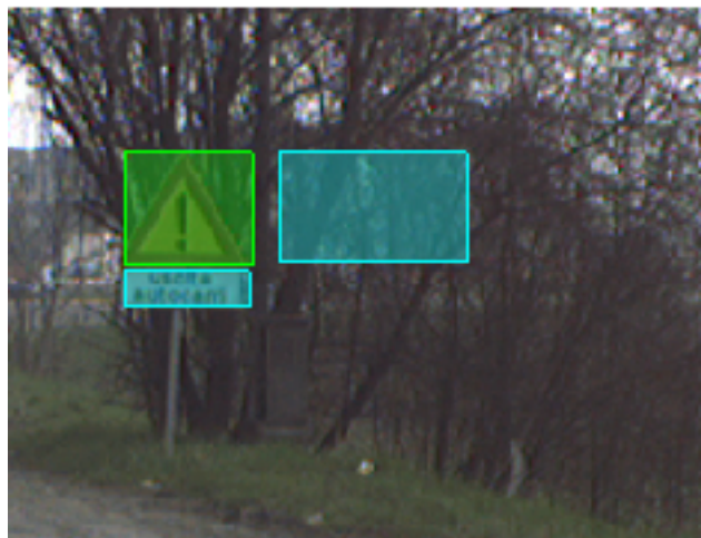
Figura 6.10: Esempio di errata validazione di un'espansione destra: i rami, trovandosi alla stessa distanza del segnale dalla telecamera, generano un valore di disparità prossimo a quello del cartello e quindi sono erroneamente validati.
