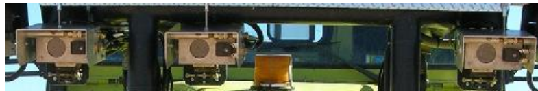
Figura 1.2: Una foto ravvicinata del sistema a 3 telecamere del TerraMax. Il sistema del TerraMax2 è simile, con le telecamere montate in corrispondenza del punto più alto del parabrezza all'interno dell'abitacolo.
