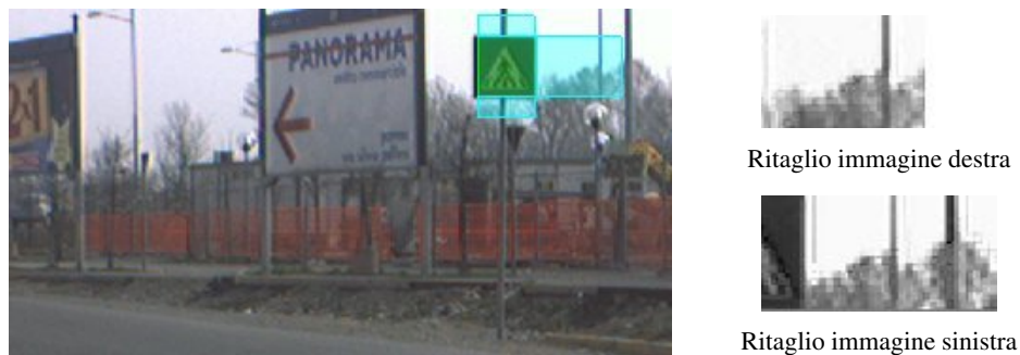
Figura 6.2: Calcolo della disparità errato dovuto all'occlusione (da notare anche 2 falsi positivi causati dal palo di sostegno, la cui trattazione avverrà nel paragrafo 6.3).
