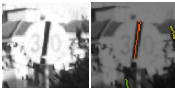
Figura 5.16: Esempio di cartello di fine prescrizione la cui banda è parzialmente nascosta.
