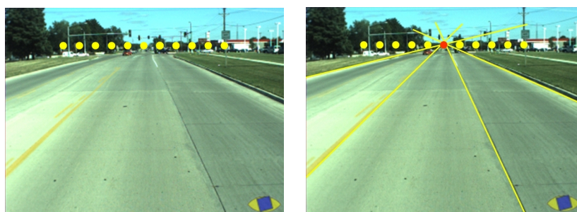
Figura 2.1: Esempio di punto di fuga.
