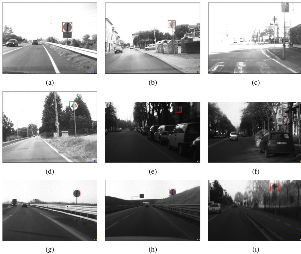
Figura 5.19: Rilevazione di cartelli di fine prescrizione: con contrasto del cartello sullo sfondo alto (a) e basso (b); (c) in assenza di contrasto con lo sfondo il cartello non può essere rilevato; (d) in un immagine rollata, in presenza di sfondo parzialmente saturato; (e) in un immagine scura; (f) ombre parziali; (g-h) alta velocità di guida; (i) immagine mossa; (continua)
