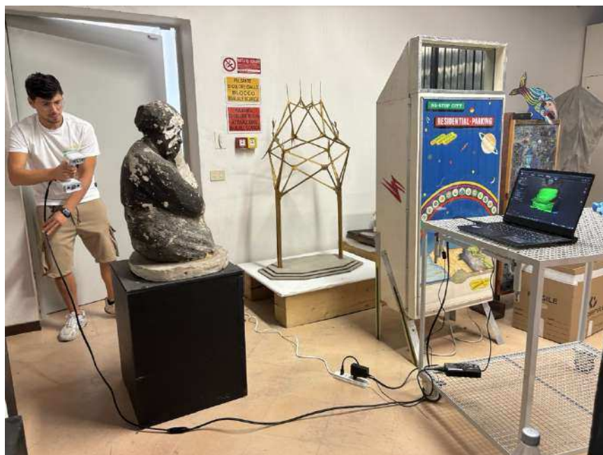
Figura 11 Figura 2 foto realizzata durante il processo di scansione 3D dell'opera "Mia madre" di Severo Pozzati, 1915, presso CSAC, dall'azienda Archimed S.r.l.s.
