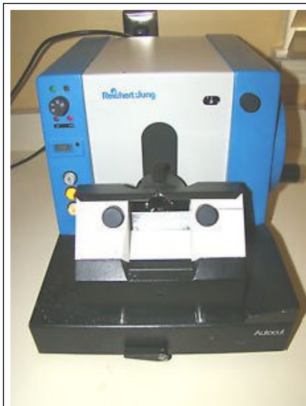
Fig. 2.5.3.1 microtomo 2040 – Reichert Jung Autocut con cui sono state effettuate le sezioni di radici successivamente osservate e fotografate al microscopio.
