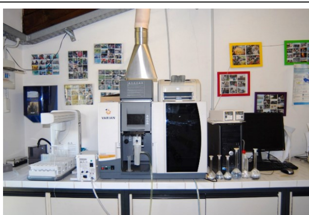
Fig. 2.4.8.2: Lo strumento per la spettroscopia di assorbimento atomico della Cascina Ambolana (Università di Parma).
