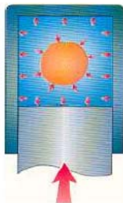
Fig. 3 Trasmissione della pressione ad un corpo sottoposto a trattamento iperbarico
