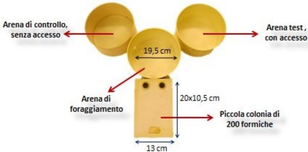
Figura 4.18 Apparato sperimentale utilizzato per gli esperimenti sul network
