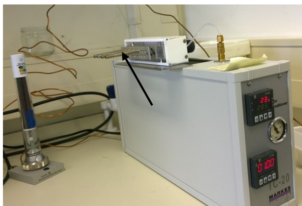
Fig.7.12 Cartucce contenenti il Tenax (freccia) sottoposte al flusso di azoto per togliere l'umidità
