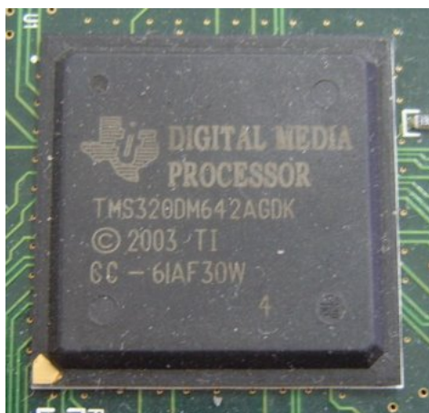
Figura 7.1: Il processore Texas Instruments TMS320DM642.
