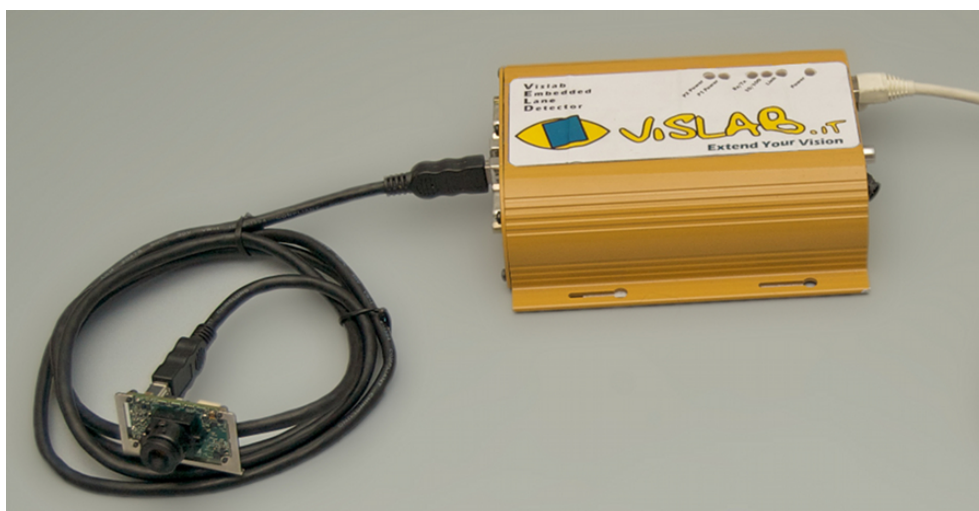
Figura 1.4: Dispositivo embedded per il rilevamento della segnaletica orizzontale.
