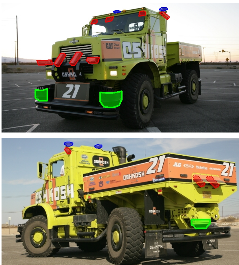
Figura 2.1: I sensori del TERRAMAX: in rosso –le telecamere; in verde –i laserscanner; in blu –le antenne GPS.
