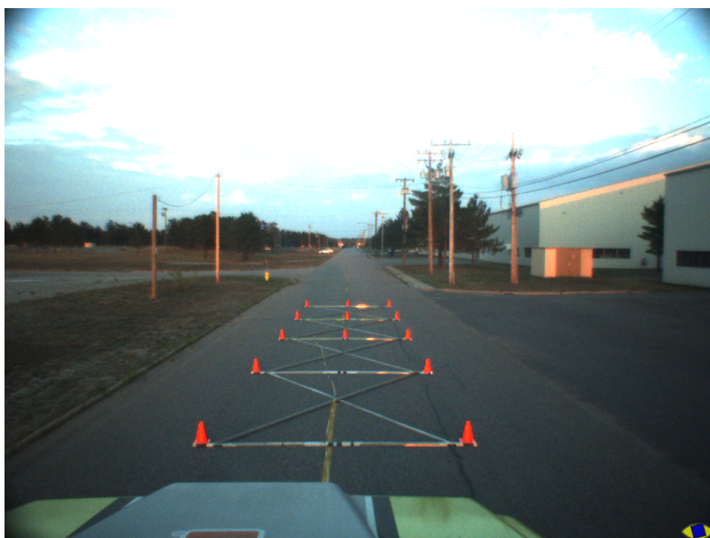
Figura 3.1: La griglia di calibrazione del sistema trinoculare.
