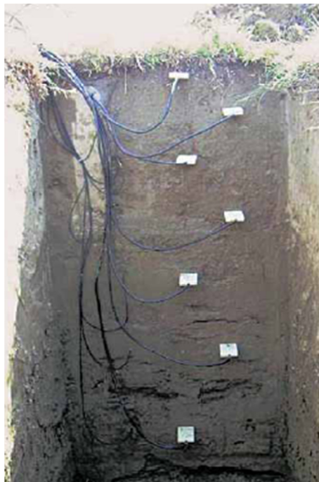
Figura 2. Posizionamento delle sonde TDR per il sito di San Pietro Capofiume.
