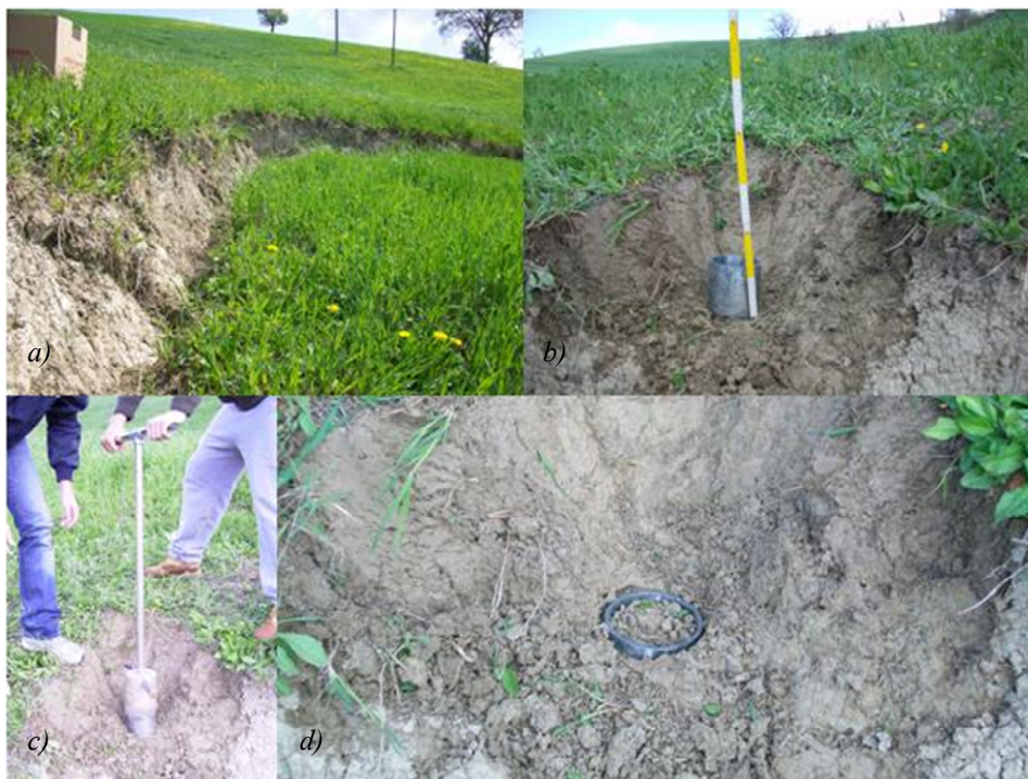
Figura 10. Fasi del prelievo in sito. a) Individuazione della nicchia di distacco. b) Posizionamento della fustella fino alla profondità d'interesse. c) Infissione della fustella per mezzo del campionatore. d) Fustella completamente riempita di terreno e pronta per l'estrazione.
