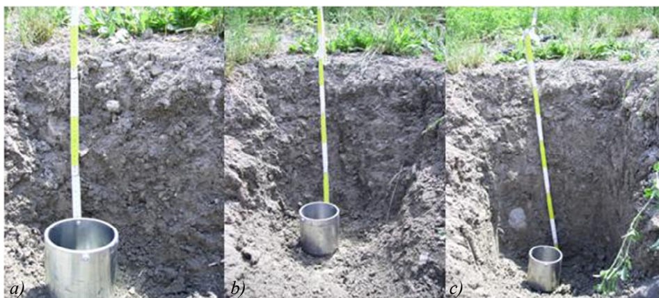
Figura 9. Profondità di prelievo dei campioni. a) Alla profondità di 0.30 m. b) Alla profondità di 0.60 m. c) Alla profondità di 1.00 m.
