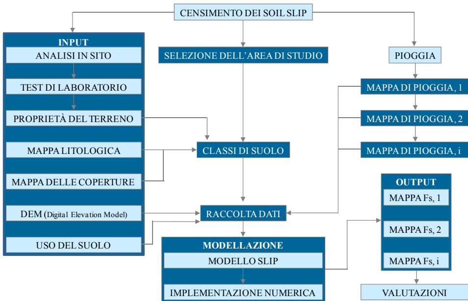
Figura 3. Diagramma di flusso rappresentativo della metodologia concettuale con la quale sono condotte le analisi di stabilità con il modello SLIP a scala regionale.
