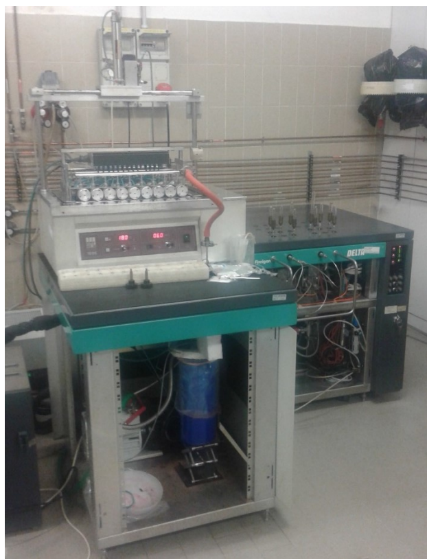
Figura 2 - Spettrometro di massa a doppio sistema d'ingresso Thermo-Finnigan Delta Plus e Thermo-Finnigan HDO device
