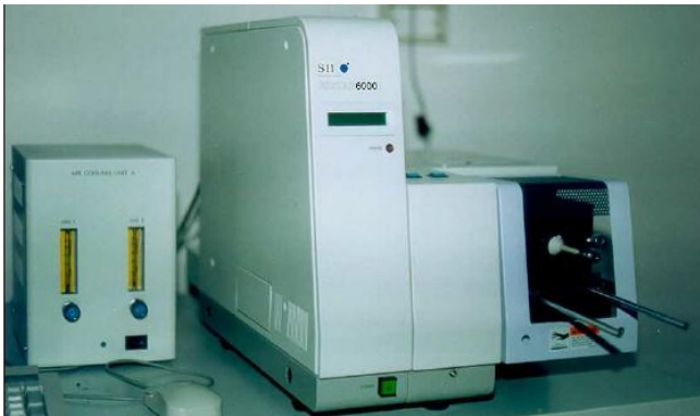
Figura 6.7: Termogravimetro mod. Exstar 6000 della SEIKO INSTRUMENTS.
