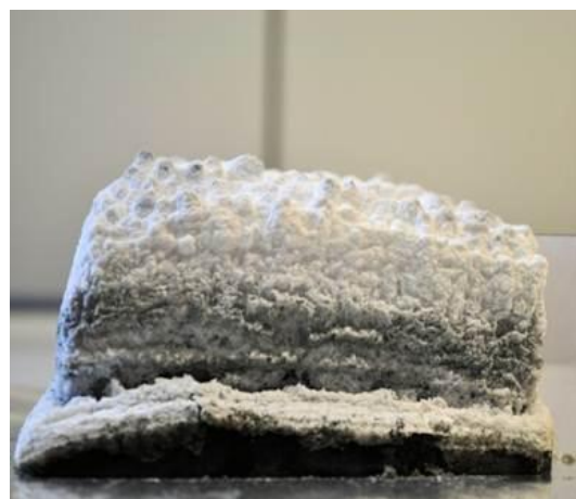
Figura 9.34: Pittura intumescente alla fine del processo di rigonfiamento.
