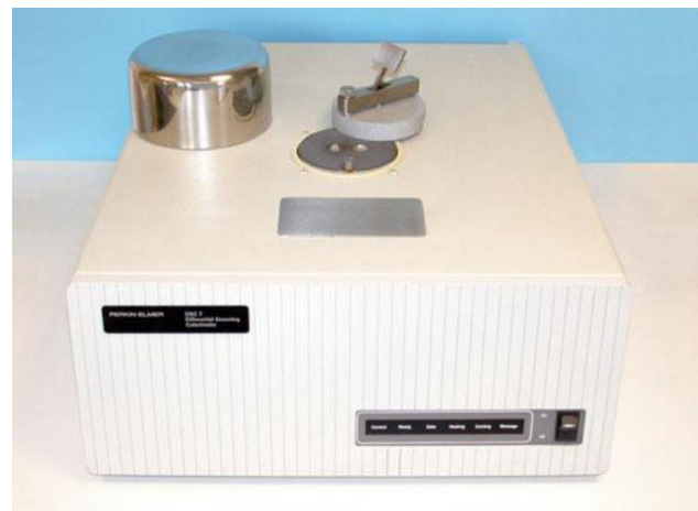
Figura 6.4: Calorimetro a scansione differenziale in uso durante le prove.
