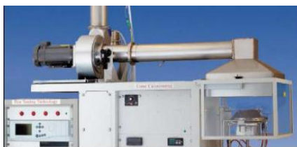
Figura 9.18: Sistema di scarico.
