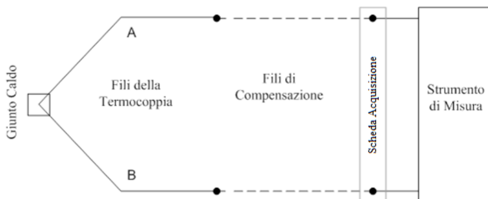
Figura 9.9: Schema teorico di una termocoppia.
