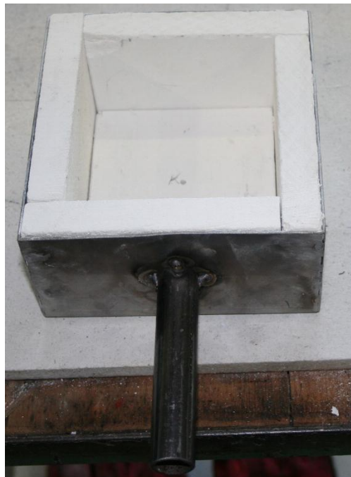
Figura 9.8: Esoscheletro contenitivo e culla per i campioni sottoposti a prove termiche a cono calorimetrico.
