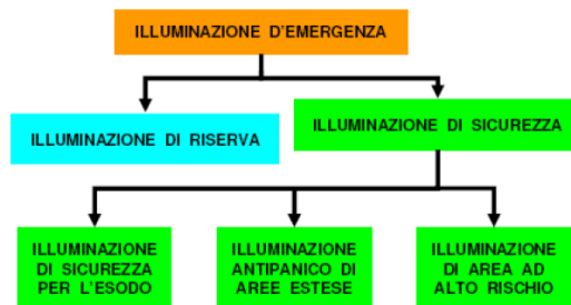
Figura 2.16: Schema di flusso dell'illuminazione di emergenza.
