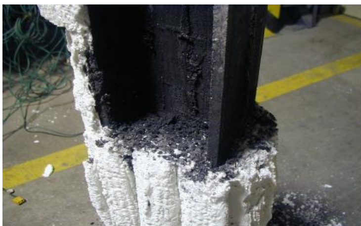
Figura 8.15: Da sinistra a destra: Preparazione, installazione in forno e risultato finale di un test in forno .
