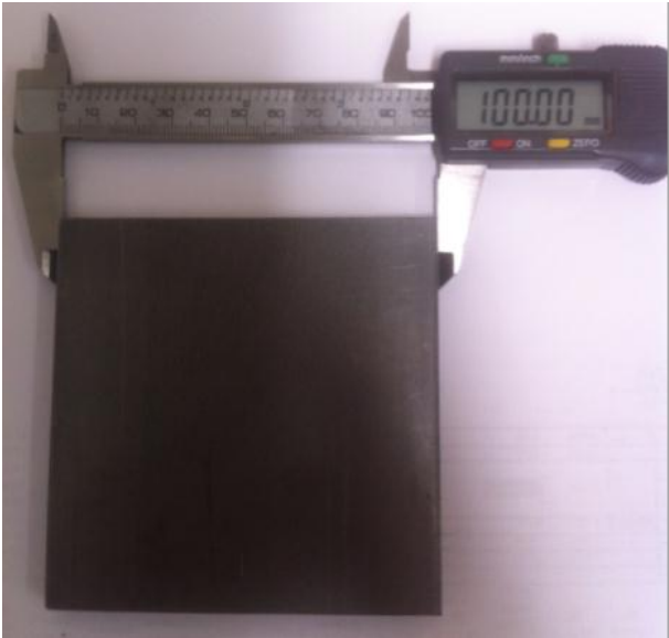
Figura 9.1: Dimensioni geometriche di una lastra di acciaio quadrata.
