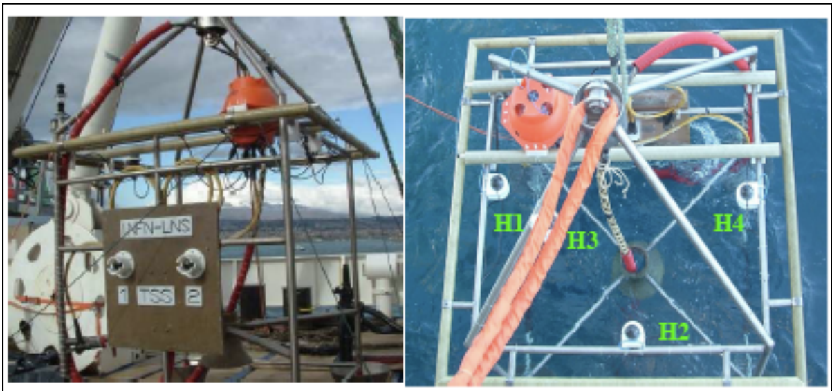
Figura 4.5. Struttura meccanica della stazione OnDe. Le lettere H1, H2, H3, H4 indicano la posizione degli idrofoni. La sfera arancione è il rivestimento della sfera di borosilicato. I cavi arancioni sono i cavi del ROV impiegato per il posizionamento della stazione.
