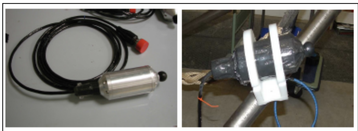
Figura 4.7. Contenitore che alloggia l'idrofono; a destra è mostrato il rivestimento con vernice poliuretanica che protegge il contenitore dalla corrosione.
