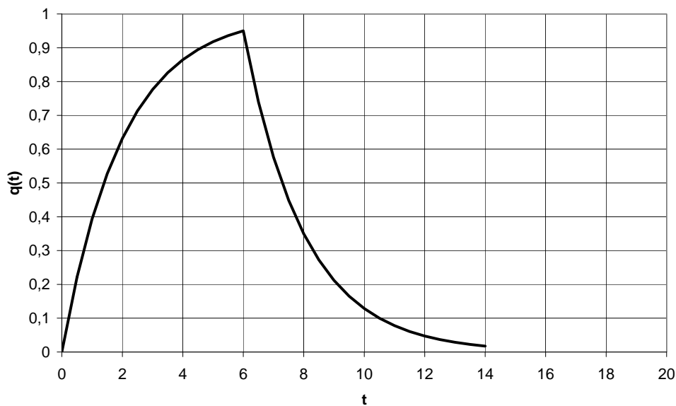
Figura 4-15 Onda di piena in uscita dall'invaso lineare ( k=2 ore) in seguito ad una precipitazione di intensità netta pari a 1mm/h e di durata 6 h.
