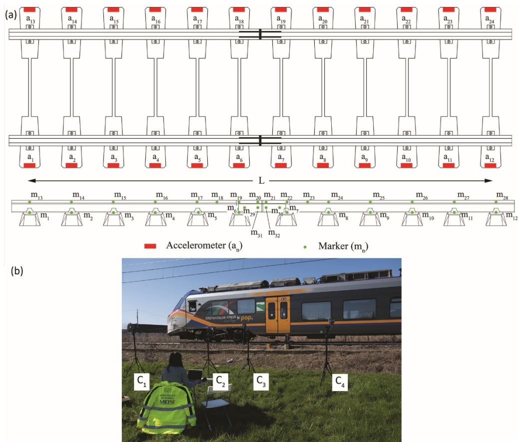
Figura 3-5 Campo prove di San Giacomo: (a) Schema degli strumenti installati sui binari; (b) Sistema ottico di rilevamento del movimento utilizzato per monitorare gli spostamenti delle rotaie durante il passaggio dei treni
