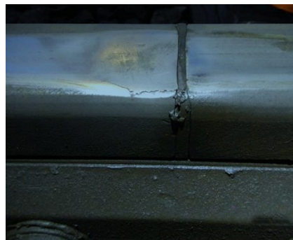
Figura 4-3 Squat della rotaia: cedimento localizzato lungo la zona di contatto ruota-rotaia
