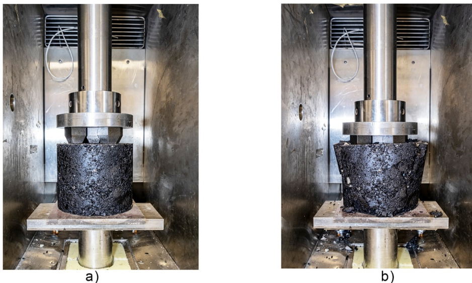
Figura 2-16 Esecuzione del punching test con AIP : a) provino dopo il posizionamento iniziale; b) provino al termine della prova
