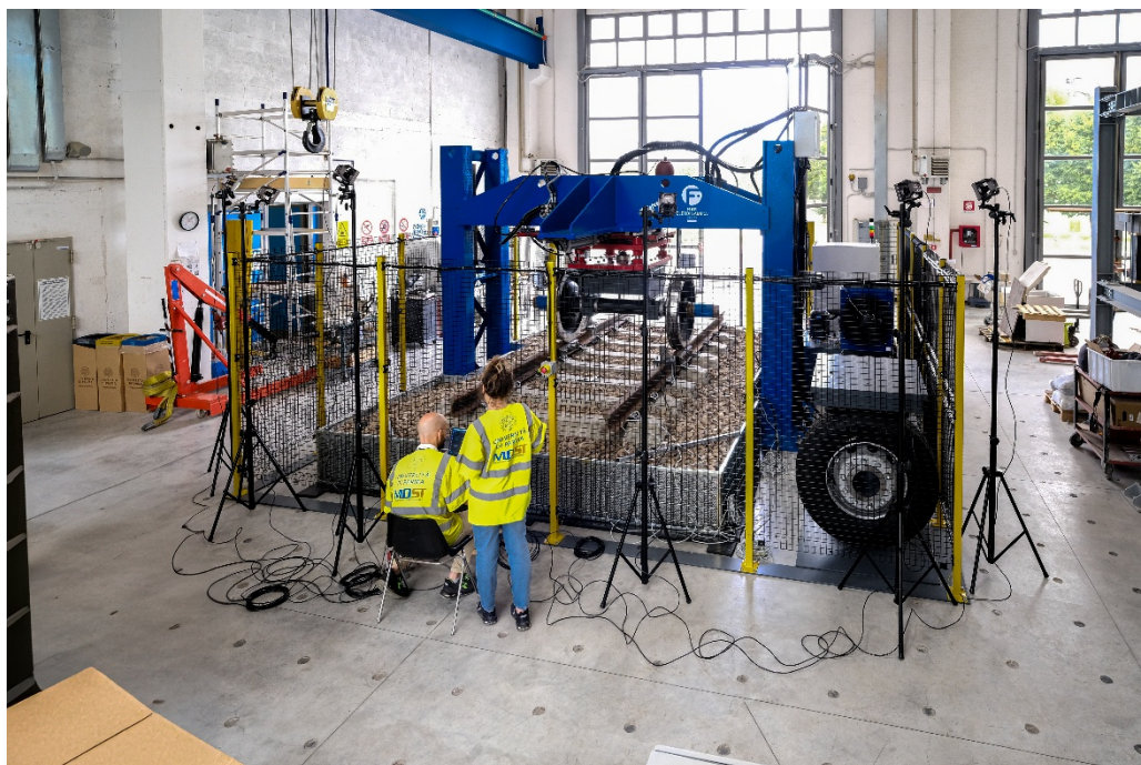
Figura 5-12 Posizionamento telecamere per il tracciamento ottico degli spostamenti
