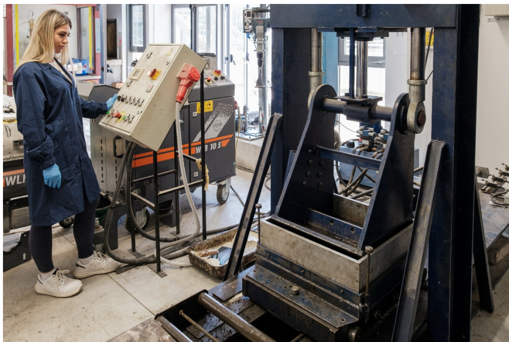
Figura 5-6 Realizzazione lastre sub-ballast con compattatore a lastre
