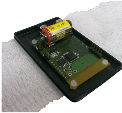
Figura 2.1: Modulo wireless con accelerometro posizionato su una banda medicale elastica
