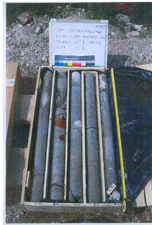
Tratto inferiore della colonna JGT8 da 15.00 fino a 19.00 m da p.c.
