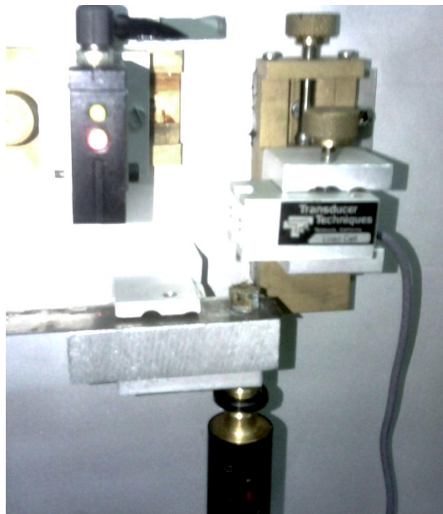
Figura 18 - Macchina di prova per micro compressione.
