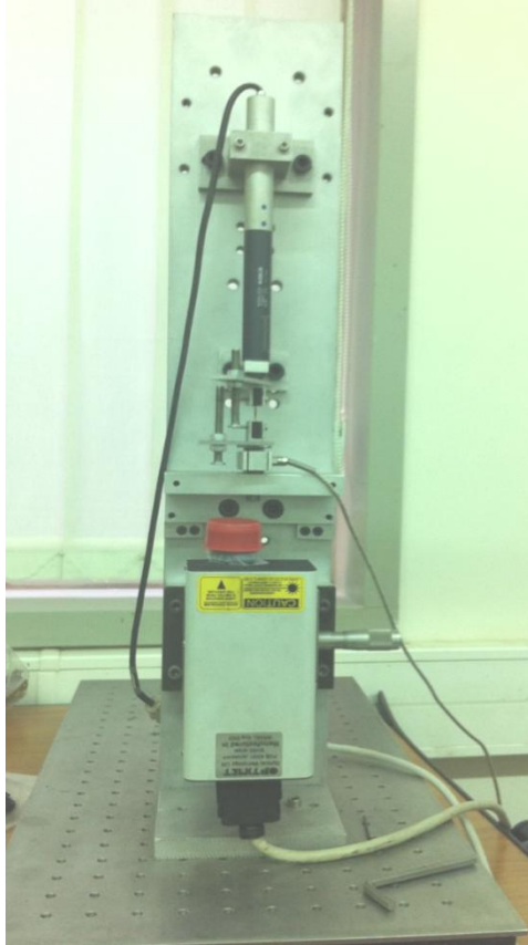
Figura 17 - Macchina di prova per microtrazione.
