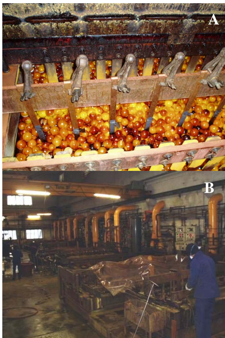
Figura 5. (A) Cromatura Galvanica – palline da ping-pong posizionate sulla superficie del bagno di cromatura per aumentare la superficie adsorbente le nebbie di anidride carbonica. (B) Cromatura Galvanica – operai al lavoro alle vasche di cromatura.
