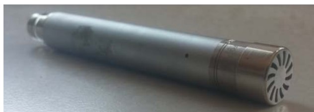
fig. 5.6 - Uni dei microfoni omnidirezionale utilizzati nelle prove
