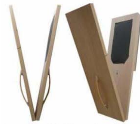
fig. 4.5 - clappatore per la misura del tempo di riverbero
