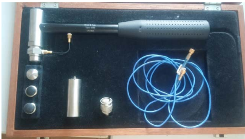
fig. 5.1 - Martello strumentato usato nelle prove.
