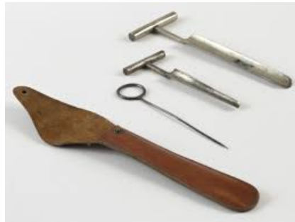
fig. 7.1 - Strumenti tradizionali del battitore (martello, sonda, ago)
