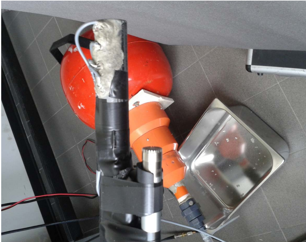
fig. 3.1 - Prototipo di impedenziometro costruito in laboratorio
