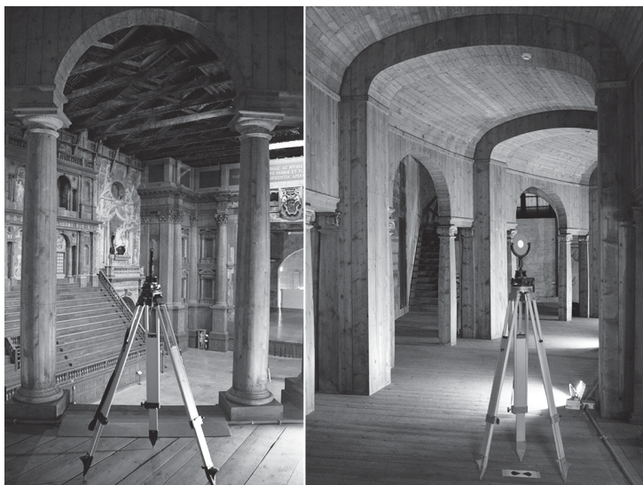
Figura 128 Alcuni dei punti di stazione utilizzati durante la campagna di rilievo laser scanner.
