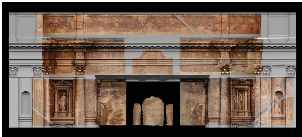
Figura 154 Sovrapposizione dell'ortofoto dell'affresco al modello digitale del proscenio. Scala originale 1:50.
