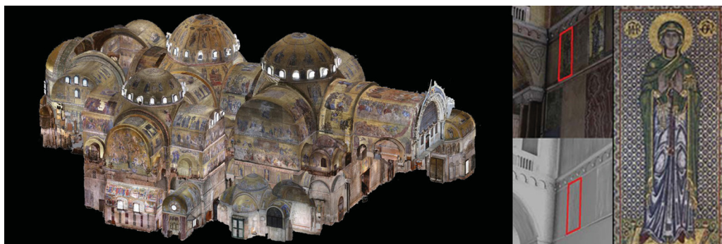
Figura 25 Basilica di San Marco a Venezia. A sinistra nuvola di punti dell'intera struttura. A destra estratti del modello mesh , del modello NURBS e dell'ortofoto.
