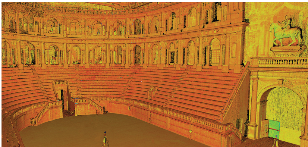
Figura 130 Particolare della nuvola di punti ottenuta dal rilievo laser scanner.
