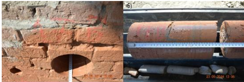
Figura 89 a) foro N°17B; b) carota N°17B.
