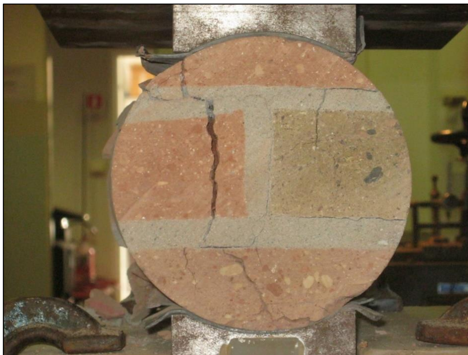
Figura 113 Fase finale della prova di schiacciamento del provino.
