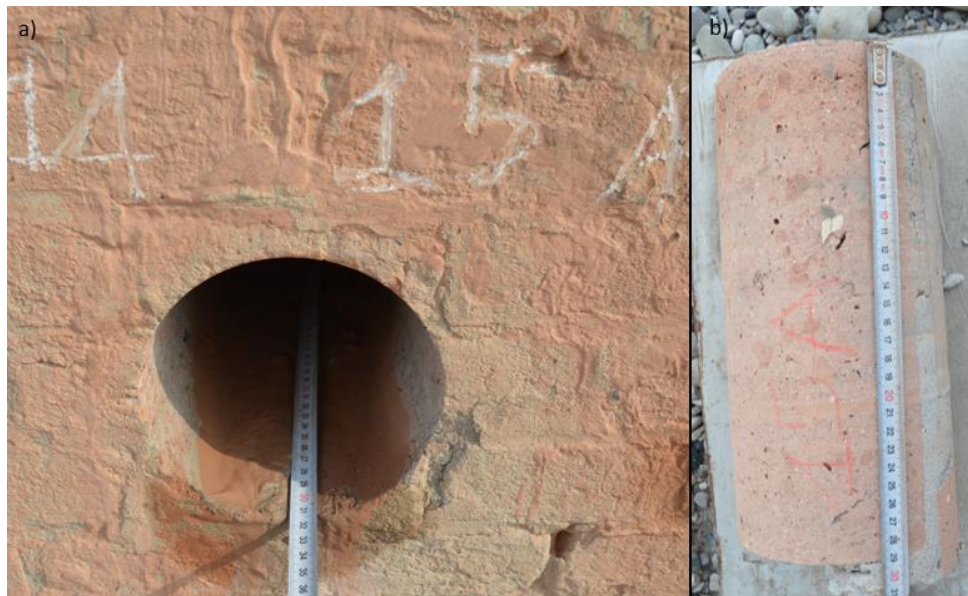
Figura 83 a) foro N°15°; b) carota N°15A.
