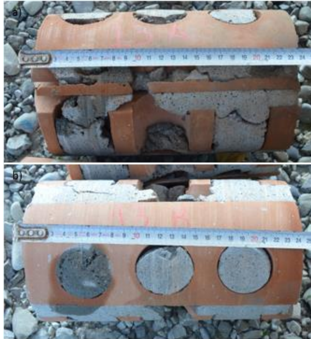
Figura 80 a) carota N°13A; b) carota 13B.
