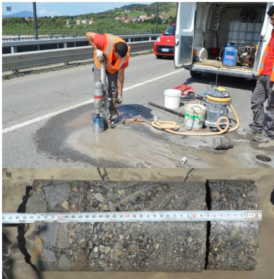
Figura 70 a) foro al di fuori della soletta; b) carota N°2.
