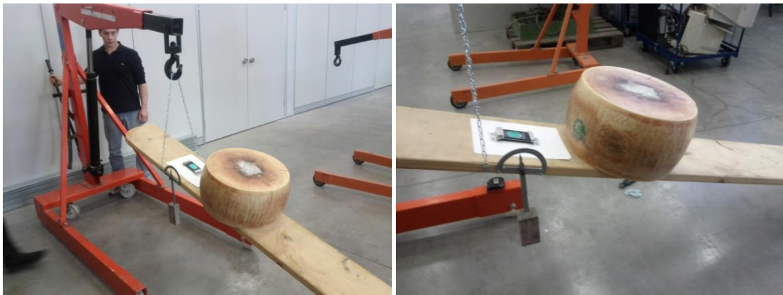
Figura 26 Prove sperimentali per la determinazione del coefficiente d'attrito tra forme di parmigiano e tavole in legno adibite per la stagionatura del parmigiano (per gentile concessione del Prof. Luca Collini).
