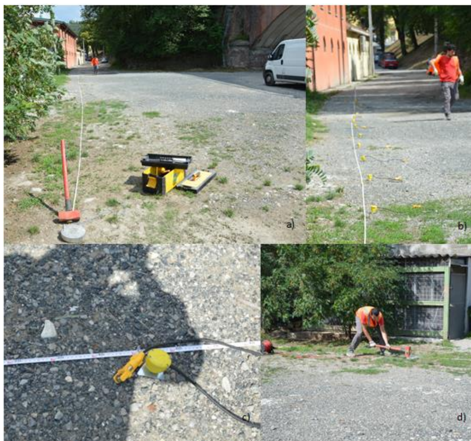
Figura 102 a), b), c) strumentazione; d) esecuzione prova MASW.
