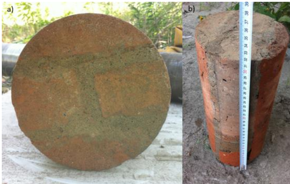
Figura 66 a) sezione ad H del provino; b) altezza del provino.
