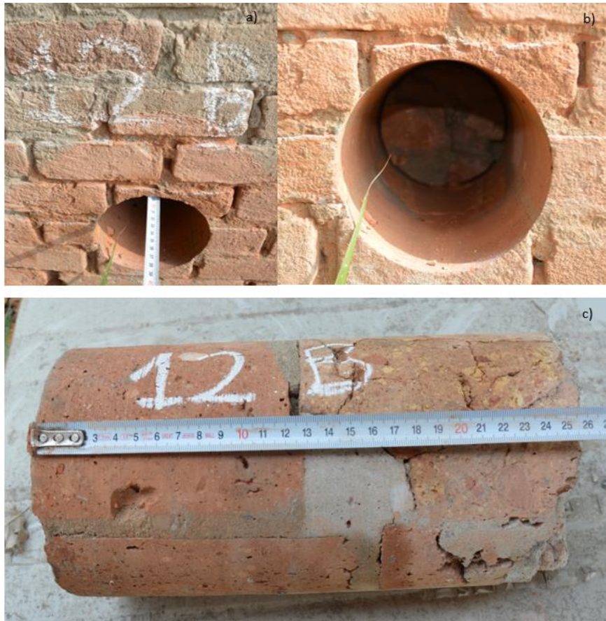
Figura 77 a) foro N°12B; b) dettaglio del foro N°12B; c) carota N°12B
