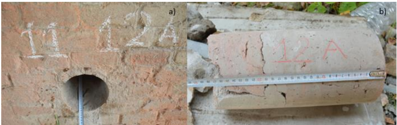
Figura 76 a) foro N°12A; b) carota N°12A.
