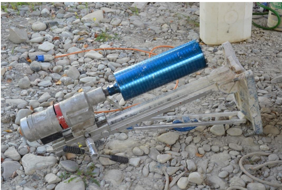
Figura 65 Carotiere utilizzato per le prove sulla muratura.
