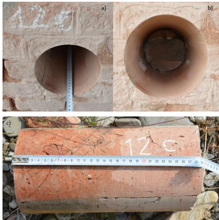
Figura 78 a) foro N°12C; b) dettaglio del foro N°12C; c) carota N°12C.
