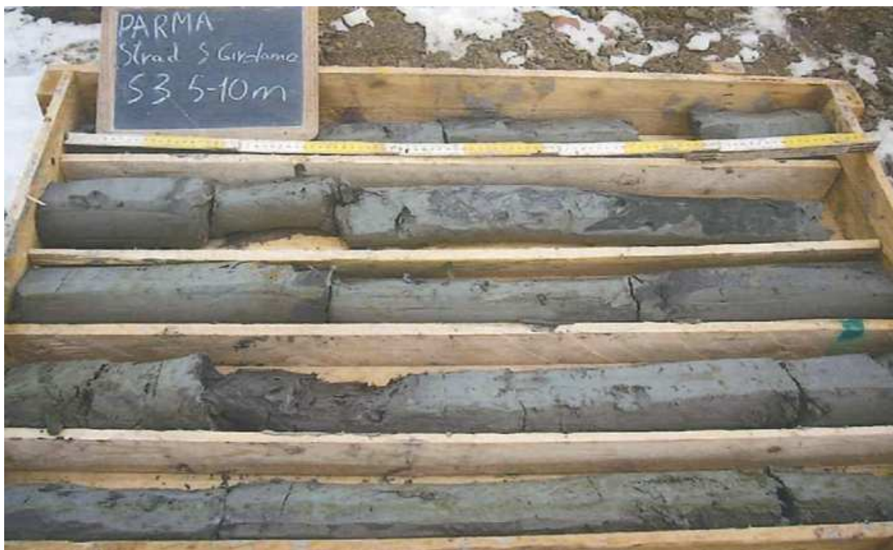
Fig. 112. Carotaggio nel sondaggio 3 di stradello S. Girolamo.
