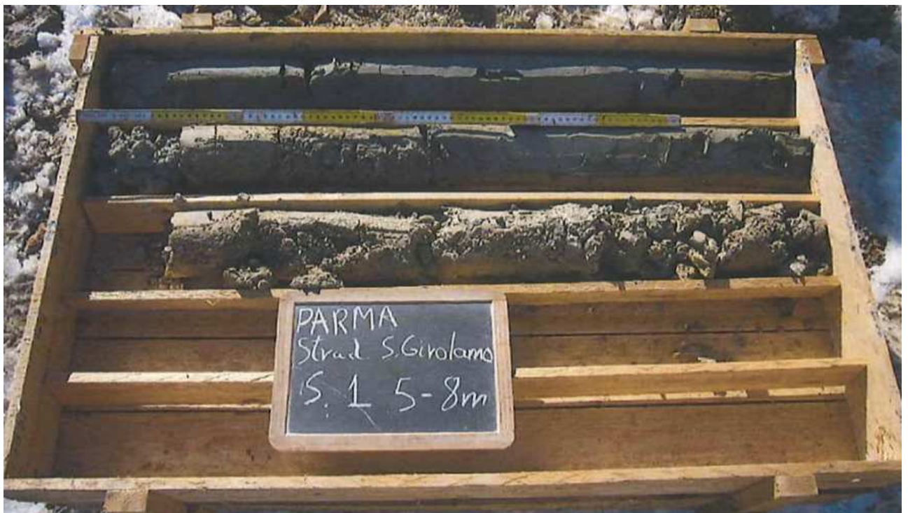
Fig. 109. Carotaggio nel sondaggio 1 di stradello S. Girolamo.
