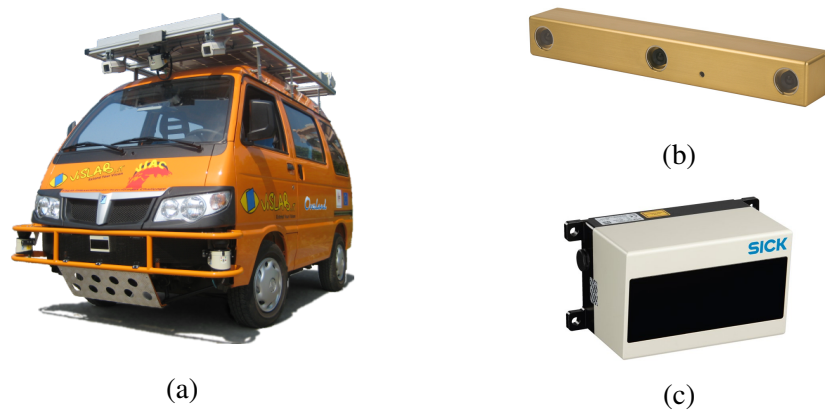
Figura 2.5: La piattaforma di registrazione. I dati sono stati raccolti utilizzando uno dei veicoli elettrici (a) che sono stati allestiti nel 2010 per prendere parte al VisLab Intercontinental Autonomous Challenge (VIAC) [21]. Il sistema di visione (b) è una Point Grey Bumblebee ® s XB3-13S2C, sincronizzata con un SICK LD-MRS-400001 LIDAR (c) funzionante alla frequenza di 12.5 Hz
