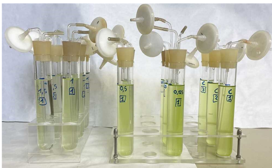
Figura 3.21 Test di tolleranza al Cr(VI) in Neocystis brevis dopo 96h di coltura. Partendo da sinistra: concentrazioni di cromo esavalente di 1,5, 1, 0,5 e 0,125 mg/L. A destra le 3 repliche di controllo. Si può notare una riduzione della colorazione verde all'aumentare della concentrazione di cromo alle 96 ore.
