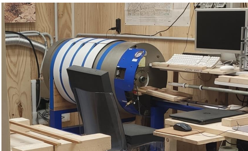
Figura 66 – Magnetometro criogenico 2G Enterprises DC-SQUID modello 755 all'interno di una stanza schermata dai campi magnetici presso il Laboratory of Magnetostratigraphy and Paleogeography (PalMag) dell'Università di Milano
