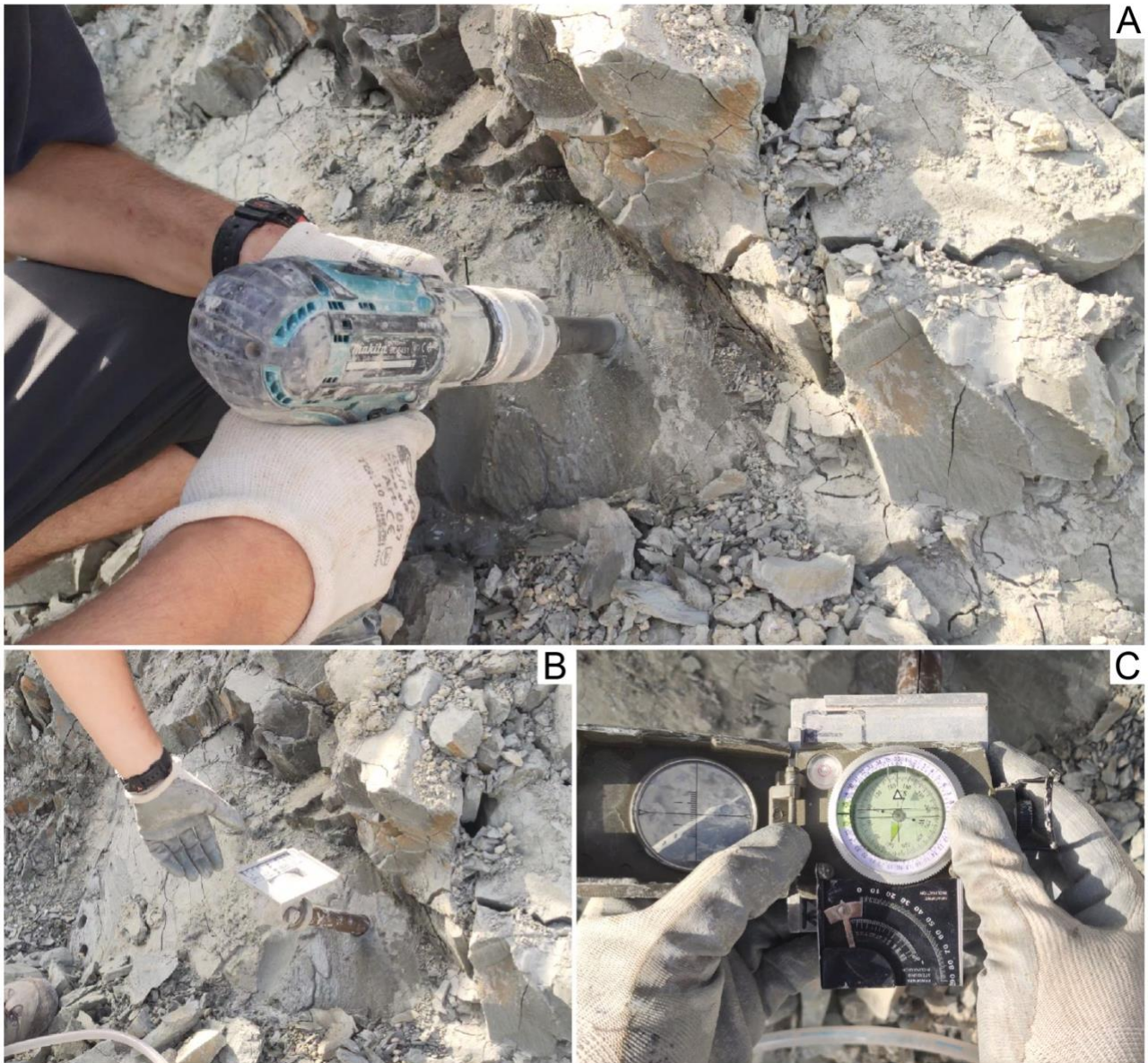
Figura 65 – A) Perforazione della roccia con carotiere collegato ad un trapano a batteria. L'acqua in pressione esce all'interno del carotiere e funge da liquido di perforazione. B) Posizionamento del supporto per estrazione ed orientazione del campione. C) Misurazione dell'immersione del campione.
