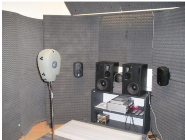
Figura 3.9 – Misura dello stereo dipolo mediante dummy-head
