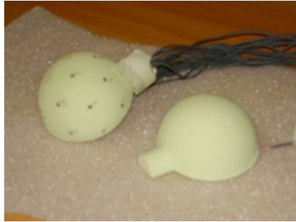
Figura A.2.9 – Inserimento delle capsule microfoniche nelle due semi-sfere
