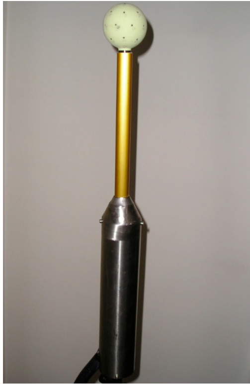
Figura A.2.10 – Microfono a 32 capsule
