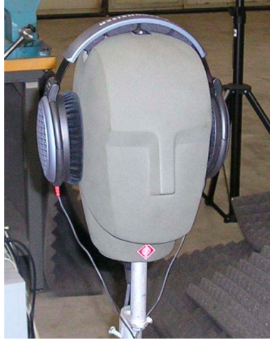
Figura 1.38 – Dummy head con cuffie per la misura delle loro funzioni di trasferimento
