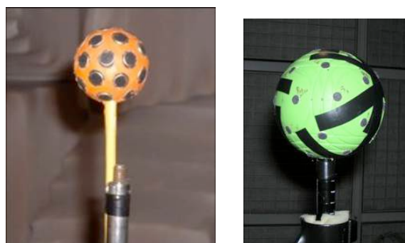
Figura 1.36 – Esempi di microfoni HOA con disposizione delle capsule regolare (Moreau, 2006)
