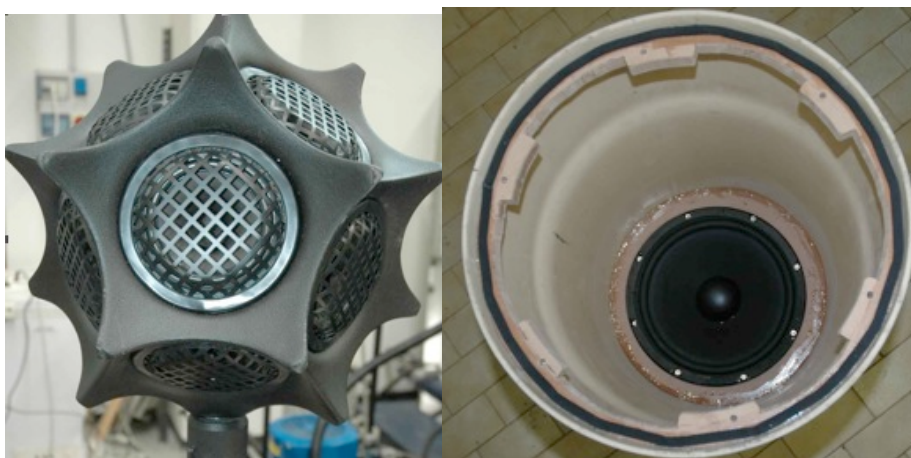
Figura A.1.1 - Dodecaedro “omnidirezionale” e cassa in PVC in cui è visibile il woofer.
