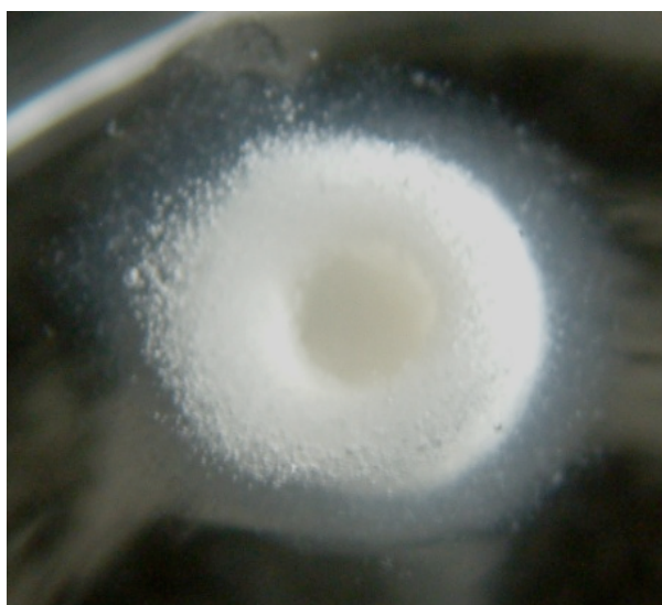
Figure 56: Camera d'aria interna di una Dome Matrix ® dopo 560 min in fluido gastrico simulato
