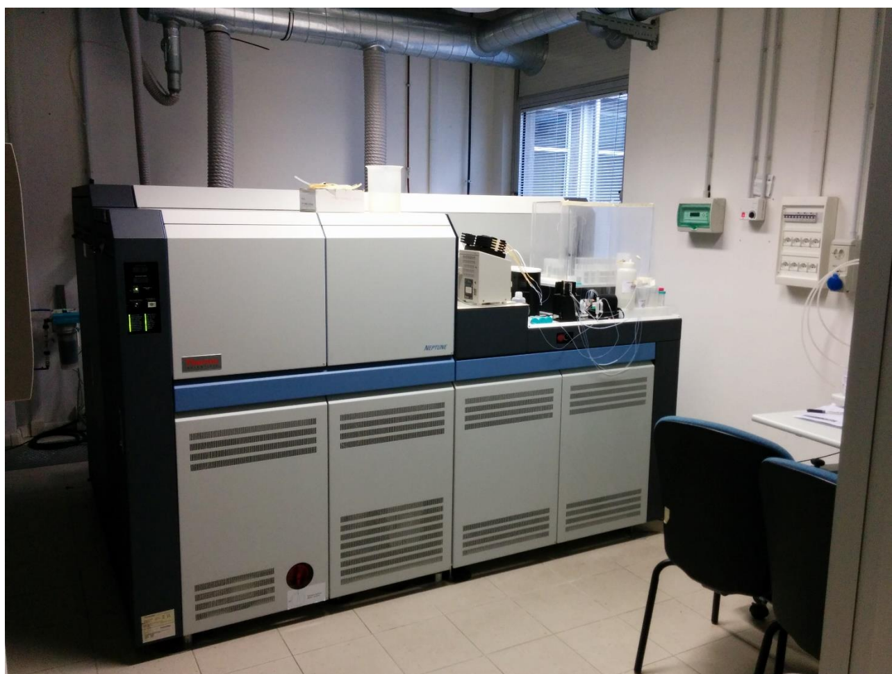
Figura 70 – Lo spettrometro HR-MC-ICP-MS – Thermo Scientific™ Neptune utilizzato per le analisi isotopiche ^{87}\text{Sr}/^{86}\text{Sr} .
