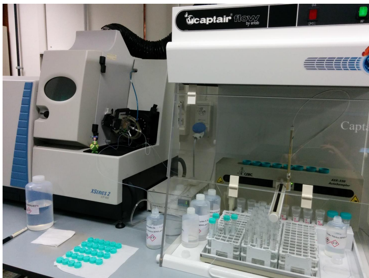
Figura 71 – Lo spettrometro ICPMS X Series II, Thermo Fisher Scientific utilizzato per la determinazione delle concentrazioni di Sr.
