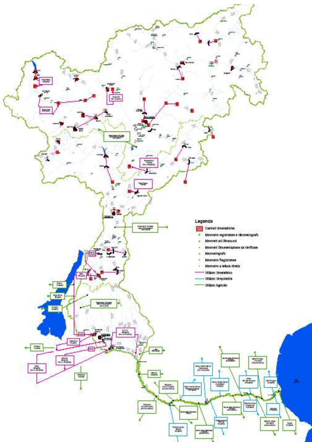
Figura 6.4 – Schema idraulico delle derivazioni nel bacino dell’Adige. In rosa le prese idroelettriche, in verde gli usi agricoli e in azzurro le prese potabili.
