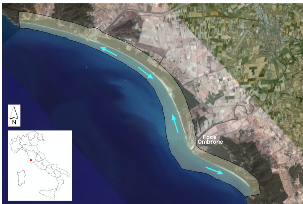
Figura 2.14. La Cella Litorale “naturale” della Foce del Fiume Ombrone (Toscana). L’area gialla semi-trasparente indica la Cella Litorale delimitata a mare dall’isobata dei 10m ed a terra dalla distanza di un km dalla linea di riva. Il verso del drift costiero, indicato dalle frecce azzurre, è molto variabile (AA.VV., 1999) (Image NASA, © 2007 DigitalGlobe, © Cnes/Spot Image, © 2007 Tele Atlas).
