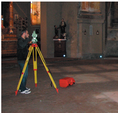
Fase di ribattuta dei target riflettenti posizionati alla base delle murature con stazione totale
