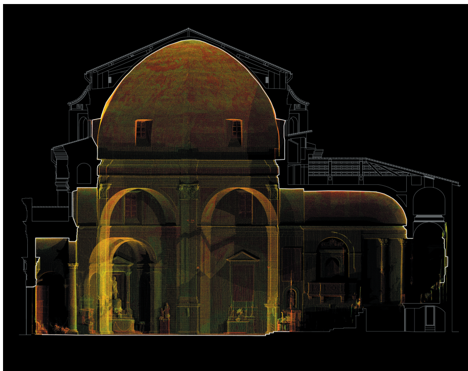
Sezione longitudinale della chiesa di Santa Maria del Quartiere realizzata dalla nuvola di punti acquisita con laser scanner e vettorializzata su cad. Per la rappresentazione degli elementi proiettati si è mantenuta l'immagine della nuvola di punti in quanto metricamente corretta e misurabile.
