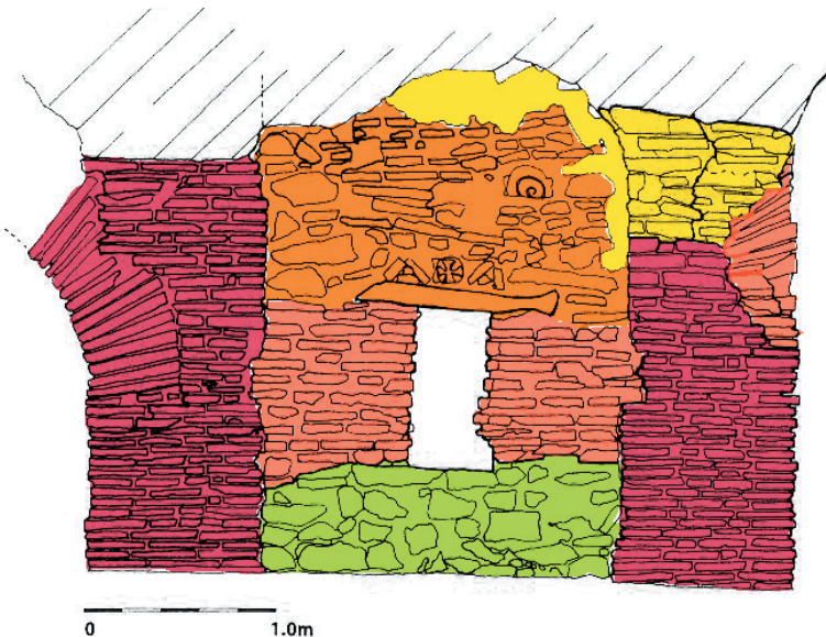
Analisi stratigrafica del precedente struttura muraria in cui, attraverso i colori si evidenzia la diversa datazione delle parti di muratura e con il diagramma di Harris, la successione temporale delle stesse.
