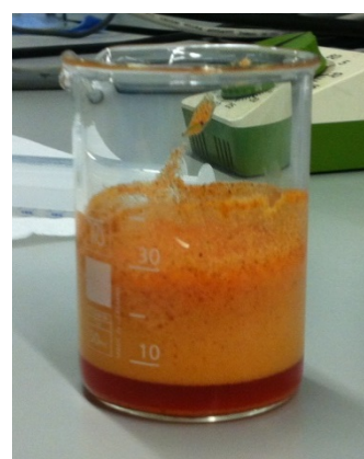
Figura 36. Sospensione ottenuta dopo la disgregazione di una compressa BS30-RIF#3, una compressa BS30-ISO#3 e due compresse AT35-GLYACE in 10 ml di acqua deionizzata , in un cucchiaino (sinistra) e in un becker (a destra).
