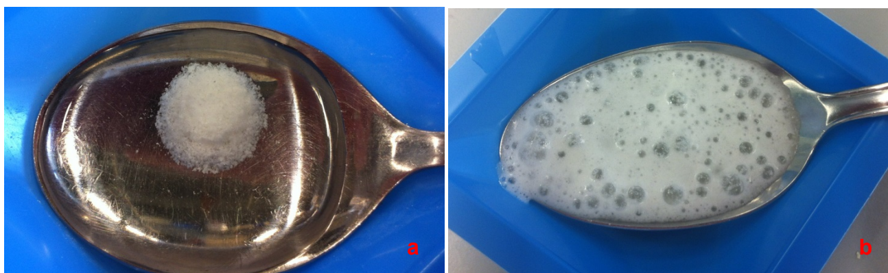
Figura 34. Una compressa BS30-ISO#3 disgregata in 10 ml di acqua deionizzata (a), e una compressa BS30-ISO#3 e una compressa AT35-GLY disgregate in 10 ml di acqua (b)
