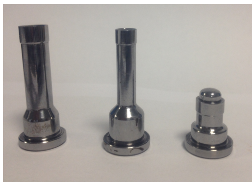
Figura. 11. Punzoni Dome Matrix®. A sinistra il punzone terminale inferiore, al centro il punzone per incastro inferiore, a destra il punzone femmina superiore.
