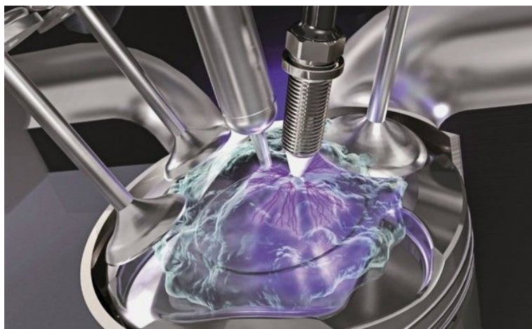
Figura 7: Rappresentazione 3D della generazione 1 del sistema ACIS (immagine per gentile concessione di Federal Mogul Powertrain).
