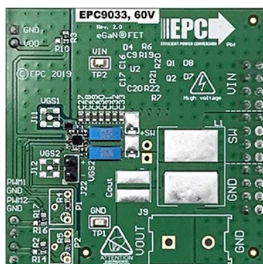
Figura 46: Scheda di prototipazione EPC9033 60V 40A, con half bridge realizzato con dispositivi GaN.
