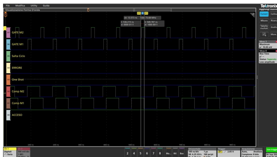
Figura 114: Funzionamento nominale del sistema in condizioni di sfasamento dei segnali d'ingresso.
