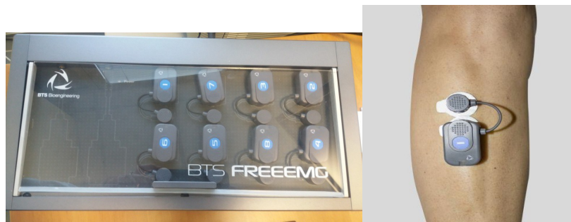
Fig. 9. BTS FreeEMG, a sinistra elettromiografo ad 8 canali, a destra applicazione della Sonda elettromiografia con sensore predisposto
