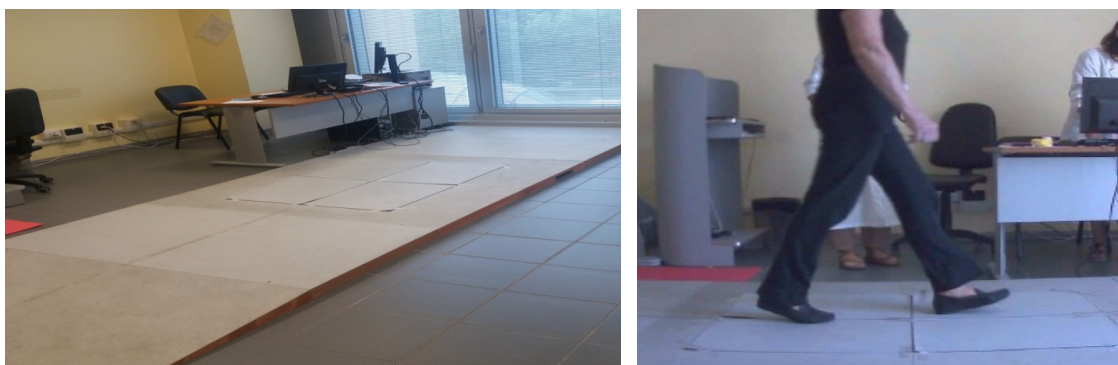
Fig 10: Pedana BTS P6000. A sinistra le quattro pedane dinamometriche, a destra esempio di un esame eseguito presso il Laboratorio di Analisi Clinica del Movimento
