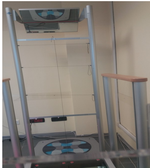
Fig7: sistema Podata 2.0: pedana stabilometrica e verticale di Barrè presso il Laboratorio di Analisi Clinica del Movimento di Parma
