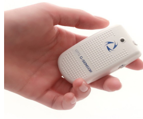
Fig. 6. Accelerometro triassiale con collegamento bluetooth
