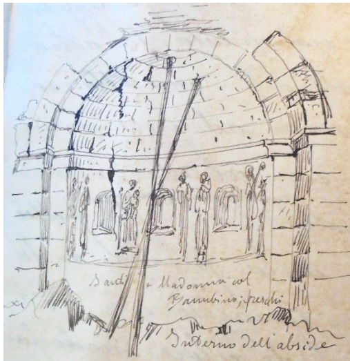
Fig. 384 – Mignano (Vernasca, PC), oratorio di San Geminiano – schizzo dello stato del catino absidale nel 1911 (lettera soprintendente L. Tesi, 31.1.1911 – ACSRoma, Min. Pub. Istr., Dir. Gen. AABBA, Divisione I – 1920-24, b. 1405 “6. Piacenza Provincia F-Z Monumenti”, fasc. 7 Vernasca – chiesetta di Mignano)
