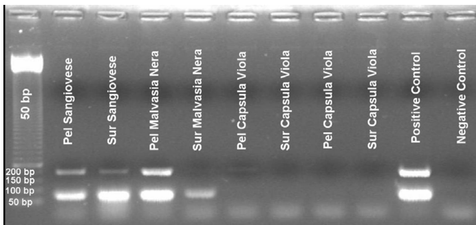
Figura 19. Elettroforesi su gel di agarosio (2% p/v) delle PCR duplex controllo estrazione DNA di lievito su vini sperimentali e commerciali. Gli ampliconi presenti corrispondono a 201 bp (PCR specifica per DNA di Vitis vinifera ) e 70 bp (PCR specifica per DNA di lievito).
