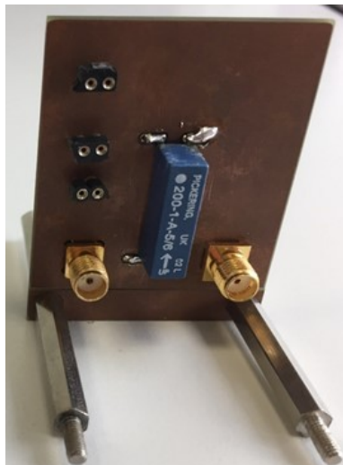
Figura 4.3: PCB realizzata con Altium Designer .
