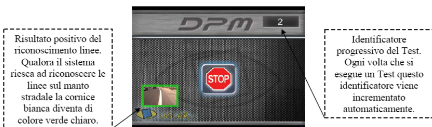
Figura 1.11: Schermata del sistema DPM durante l'esecuzione di un test.
