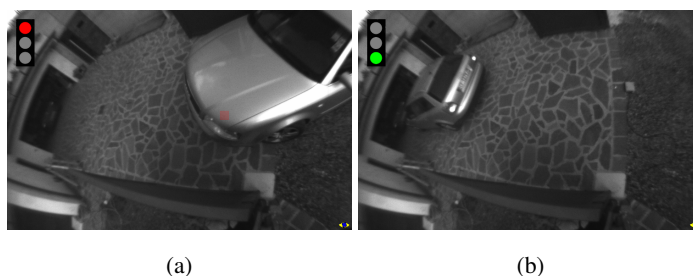
Figura 2.27: Presenza automobile, oggetto rilevato durante il passaggio a e successivamente ignorato b .
