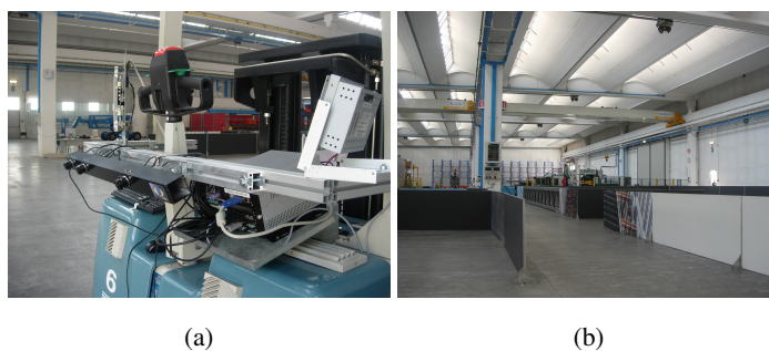
Figura 3.6: BarraTrinoculare a installata sulla navetta ed uno degli scenari di test b .
