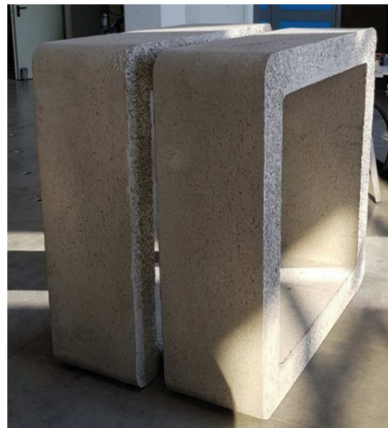
Figura 4.2 – Prolunghe pozzetti in calcestruzzo utilizzati per la realizzazione delle pareti laterali della camera di calibrazione.
