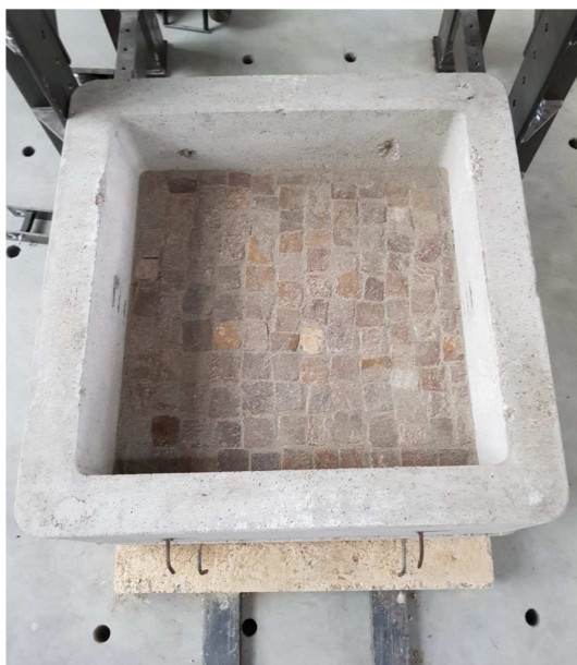
Figura 4.14 – Superficie della pavimentazione dello Schema 1.
