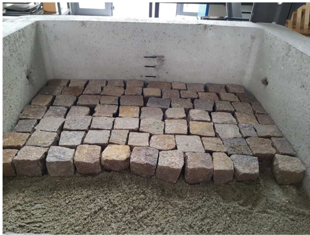
Figura 4.13 – Posizionamento dei cubetti in porfido all'interno della camera di calibrazione.
