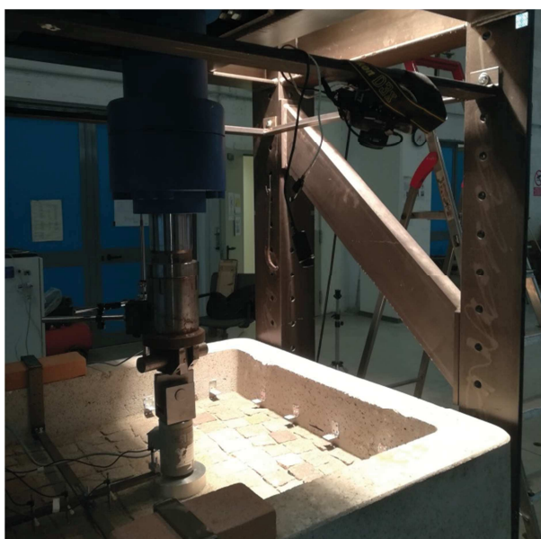
Figura 4.57 – Rilievo fotogrammetrico durante l'esecuzione della prova con pressa dinamica sulla pavimentazione dello Schema 3.
