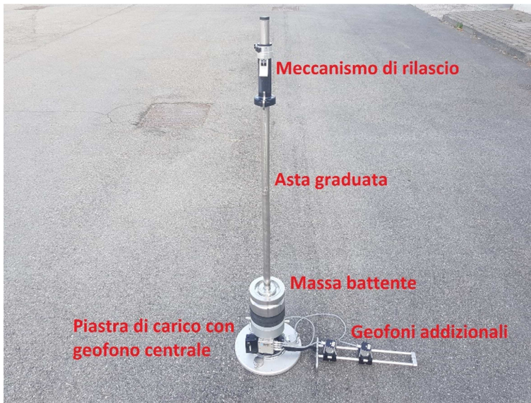
Figura 4.5 – DYNATEST 3031 LWD utilizzato per la realizzazione di prove deflettometriche a massa battente.
