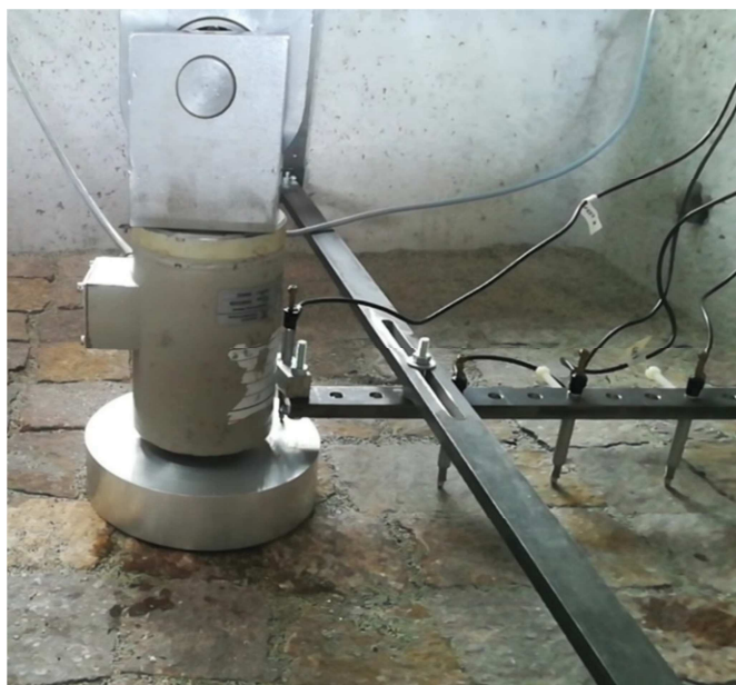
Figura 4.10 – Sostegno per il posizionamento dei trasduttori di spostamento e loro disposizione.
