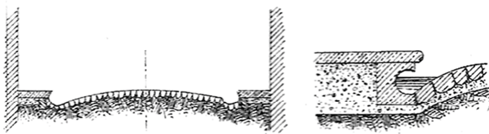
Figura 2.12 – Sezione trasversale arcuata convessa di pavimentazioni acciottolate con marciapiedi rialzati e cunette laterali [99].
