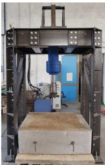
Figura 4.7 – Parte inferiore della camera di calibrazione e pressa dinamica utilizzata per test distruttivi.
