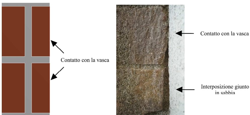
Figura 5.18 – Confronto condizioni al contorno tra modello FEM e camera di calibrazione
