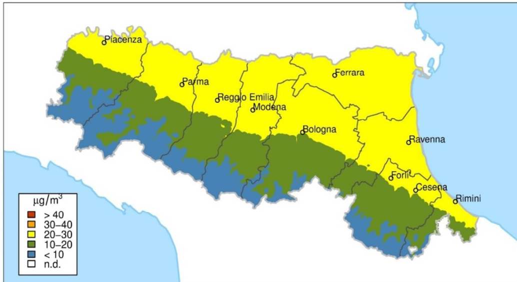
Figura 110: diverse concentrazioni annue di PM10 in regione Emilia-Romagna, in base alle elaborazioni dei sistemi NINFA+PESCO. Anno 2014
