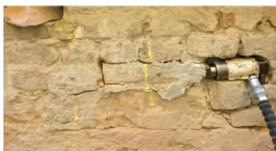
Figura 16_Prova di taglio in situ svolte presso la Ex sede della Banca d'Italia, Parma
