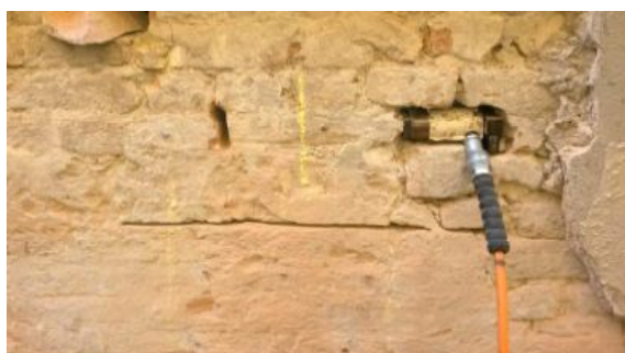
Figura 15_Prova di taglio in situ svolte presso la Ex sede della Banca d'Italia, Parma
