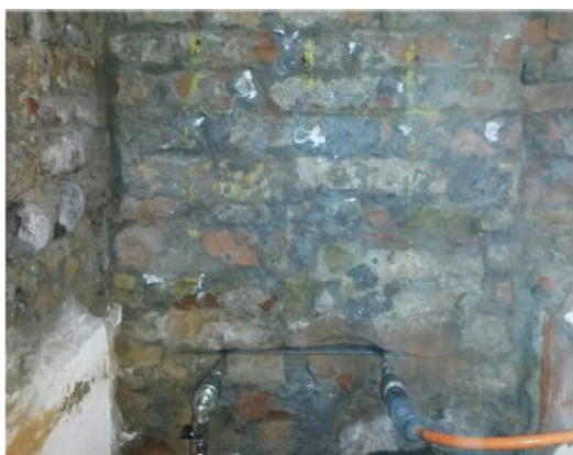
Figura 12_Campagna di indagini con martinetti singoli svolte presso la Ex sede della Banca d'Italia, Parma
