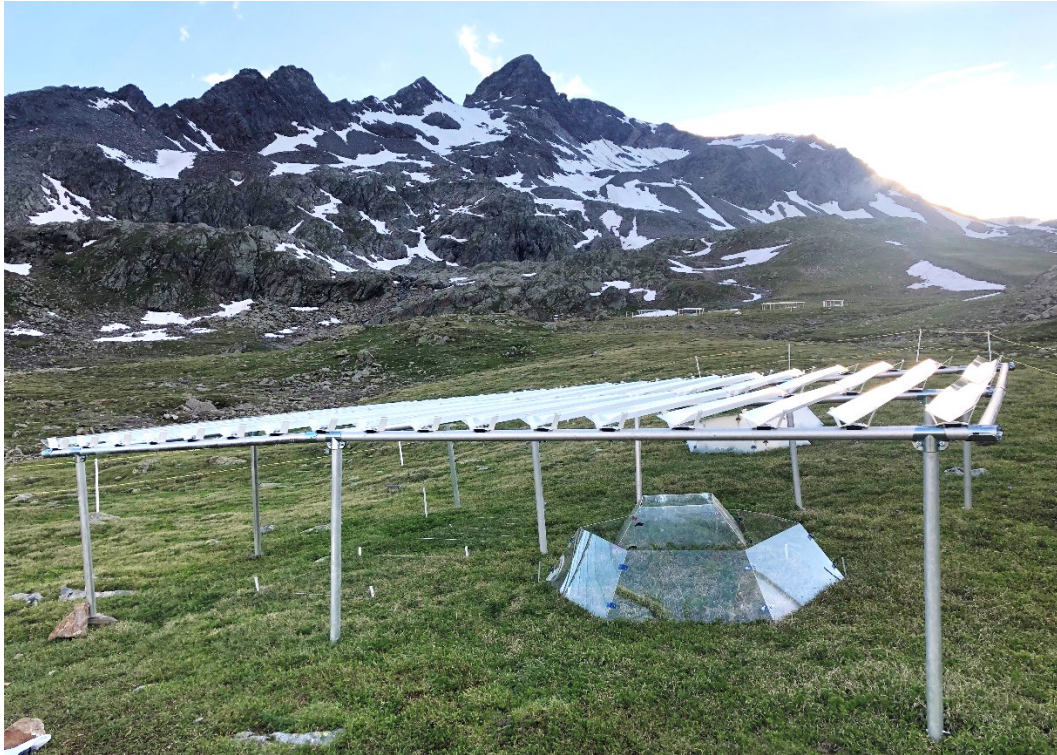
Figura 5.3: strutture utilizzate per la manipolazione sperimentale nel curvuleto: rainout shelters e open top chambers.
