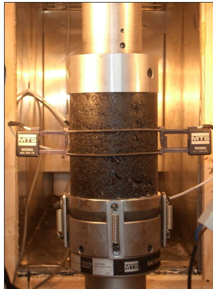
Figura 3.5 – Allestimento delle prove di modulo complesso e angolo di fase.
