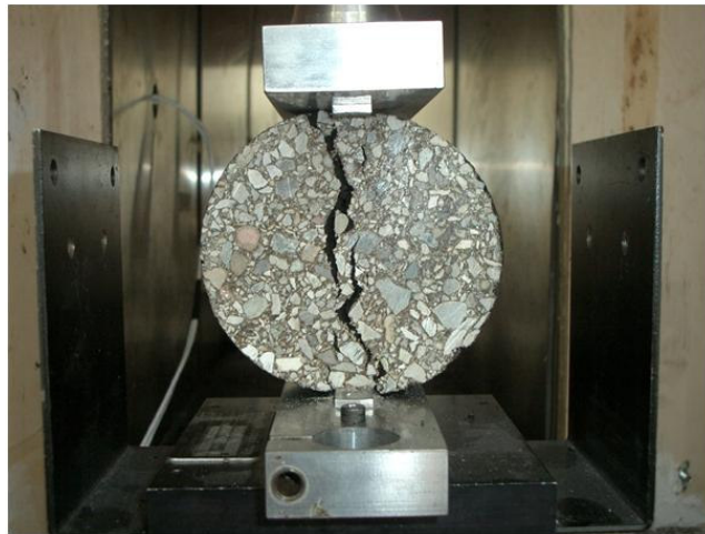
Figura 3.12 - Set-up di prova per trazione indiretta
