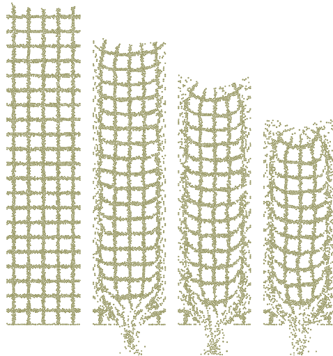
Figura 1.4 - studio del flusso di materiale granulare in uscita da un silo (Iwashita, Oda - 1995)
