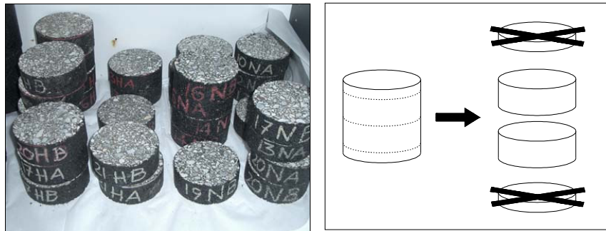
Figura 3.18 – campioni per la prova di fatica e tecnica di rettifica
