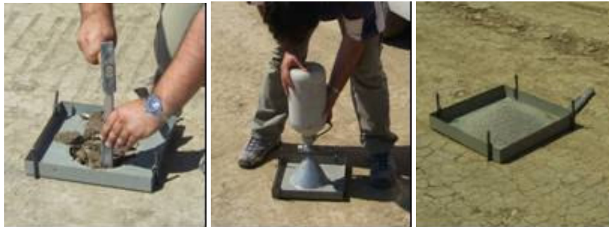
Figura 2.25 – verifica della densità tramite volumometro a sabbia
