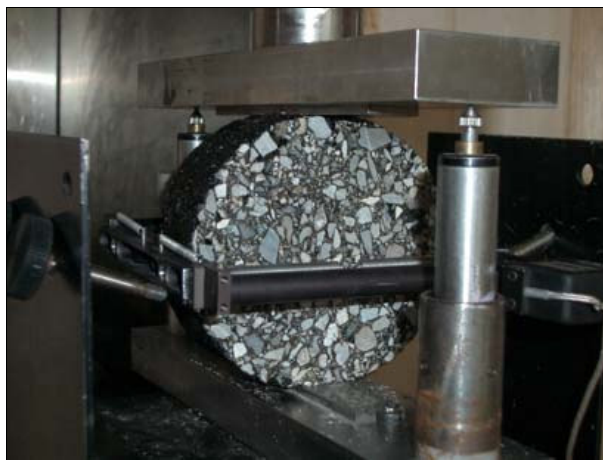
Figura 3.17 – Allestimento della prova a fatica in configurazione di trazione indiretta.
