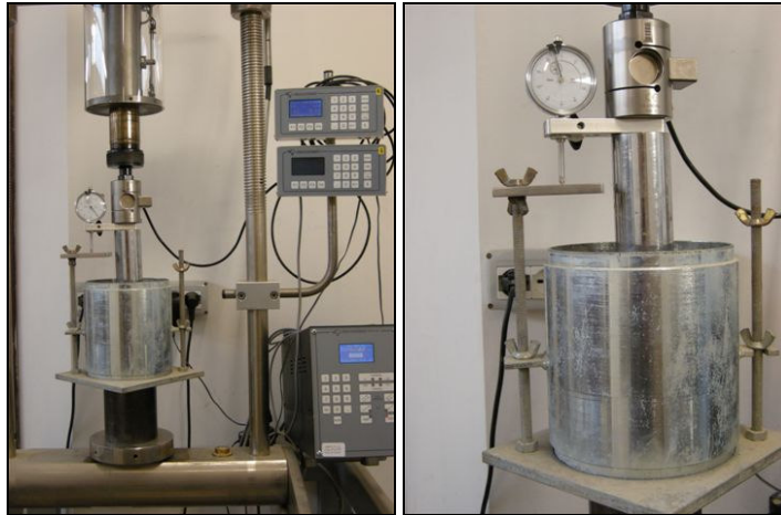
Figura 2.3 – prova CBR: castello di prova, visione di insieme (sinistra) e dettaglio (destra)
