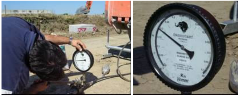
Figura 2.26 – prova di carico su piastra: allestimento sperimentale (manometro)
