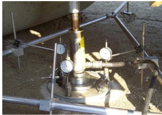
Figura 2.27 – prova di carico su piastra: allestimento sperimentale (castello di prova)
