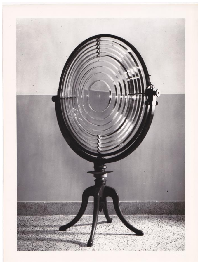
Figura 6.4. Lente di Fresnel costruita da H. Lepaute di Parigi e usata da Melloni per lo studio dell'irraggiamento lunare. La lente è presso il Museo del Dipartimento di Fisica dell'Università di Napoli. (Foto Vaghi 1945, Parma)
