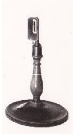
Figura 5.1. Pila composta da elementi in linea retta, per lo studio dello spettro solare. Collezione Melloni DiFeST.
