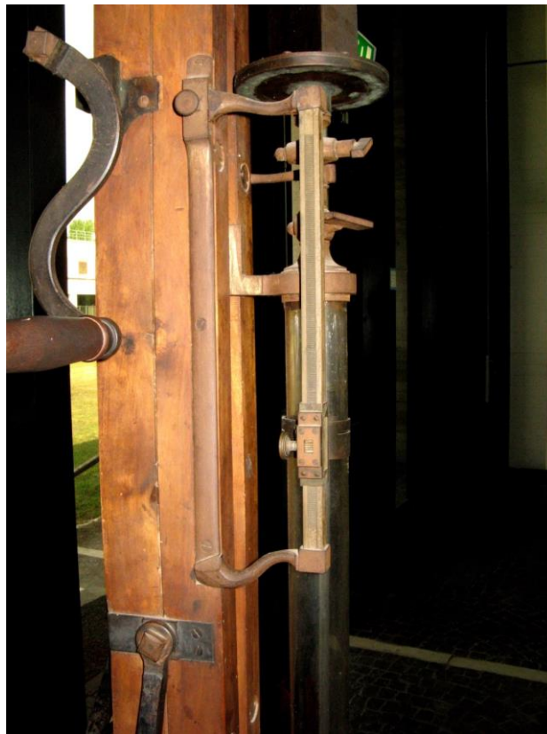
Figura 3.5. Igrometro di Melloni, particolare dell'asta per il sollevamento della colonna. Collezione Melloni, DiFeST Università di Parma.
