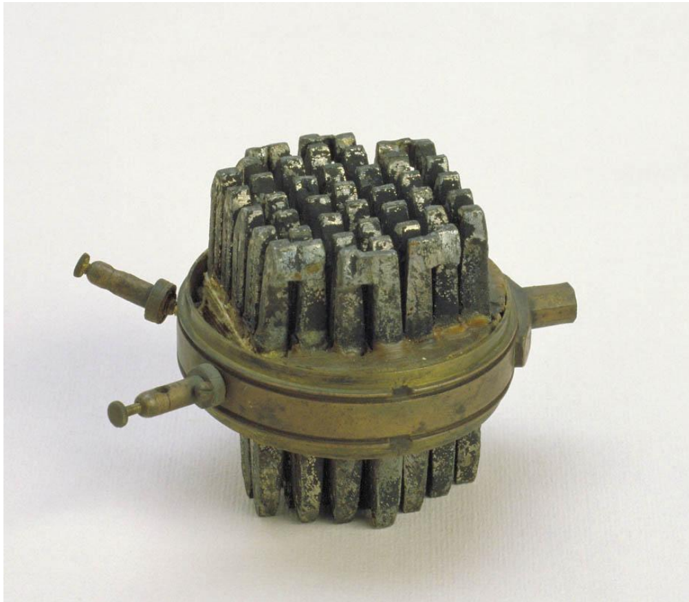
Figura 3.8. Termopila Nobili-Melloni conservata all'Istituto Museo di Storia della scienza di Firenze, IMSS, n. 1235. L'immagine mostra le barre di bismuto e antimonio, completamente assente la schermatura della pila.
