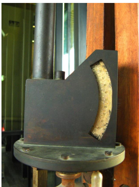
Figura 3.2. Igrometro di Melloni, particolare della scala graduata ad arco di cerchio. Collezione Melloni, DiFeST Università di Parma.
