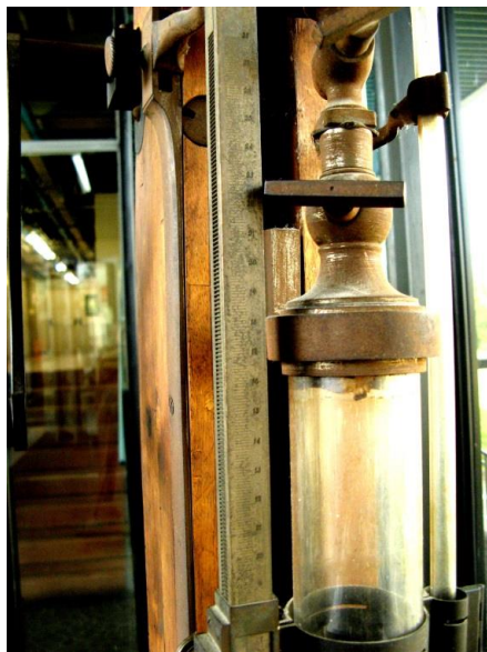
Figura 3.3. Igrometro di Melloni, particolare della scala lineare. Collezione Melloni, DiFeST Università di Parma.
