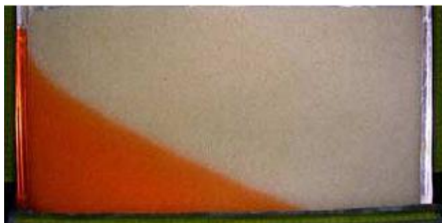
Figura 2.9: Fotografia dell'intrusione salina in falda acquifera (Goswami e Prabhakar, 2007).
