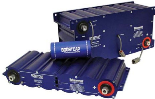
Fig. 2.14 – Supercondensatore da 2600F e 2,7 Vdc (singolo al centro, ed assemblato in serie, in sei elementi, in basso, ed in diciotto elementi, in alto) prodotto da Maxwell technologies ( http://www.maxwell.com/ ). Questo accumulatore possiede densità di potenza di 17,5kW/kg e densità di energia di 5Wh/kg.
