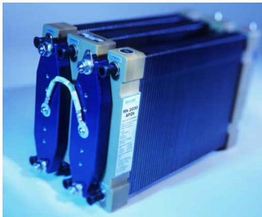
Fig. 1.4 - Cella combustibile PEM Ballard Mark 1030, potenza 1320WDC, 430mm x 171mm x 231mm. Peso a secco: 20,5 kg. ( http://www.ballard.com/ ).
