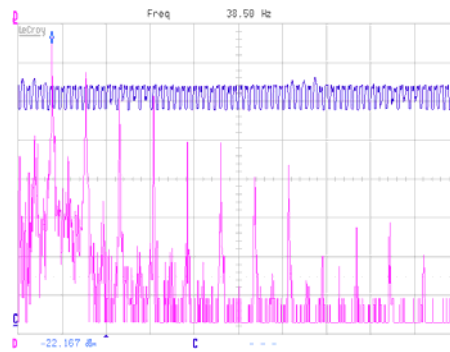
Fig. 7.29 – Misura di velocità (canale C, blu) e sua FFT (canale D, viola) a frequenza 38,50Hz.
