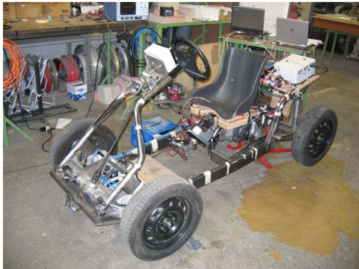
Fig. 7.35 – Veicolo assemblato. Sotto il sedile del guidatore è alloggiato il propulsore ibrido. Il pacco batterie trova posto all'avantreno.
