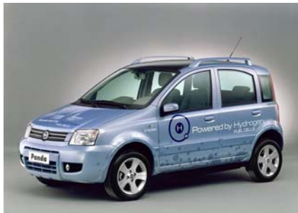
Fig. 1.3 – Fiat Panda motorizzata con un sistema a celle a combustibile di produzione Nuvera, che garantiscono un'autonomia di oltre 200 km nel ciclo urbano, con soli 5 minuti per la ricarica. Il sistema è alimentato con idrogeno stoccato ad una pressione di circa 350 bar in un serbatoio alloggiato sotto il pianale. La velocità massima è superiore a 130
