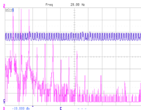
Fig. 7.30 – Misura di velocità (canale C, blu) e sua FFT (canale D, viola) a frequenza 38,50Hz.
