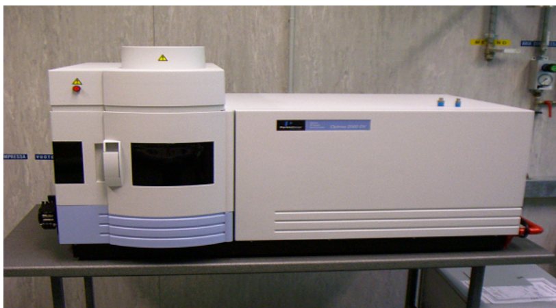
Fig.13 – Spettrofotometro ICP-OES Perkin Elmer mod.Optima 2000 DV
