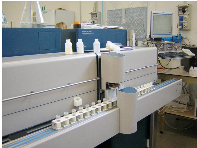
Figura 2.1: Combi: composto da Milkoscan 6000 utilizzato per la determinazione, mediante lettura nel medio infrarosso, dei contenuti di grasso e proteina nel latte e Fossomatic 5000 utilizzato per la determinazione con metodo fluoro-opto-elettronico del contenuto in cellule somatiche nel latte.
